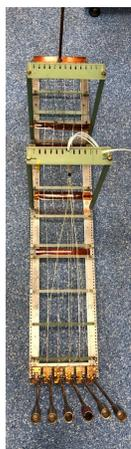
$I_c$ -Messung an laminierten REBCO-Bändern (links) und am montierten Kabelbaum (rechts)
