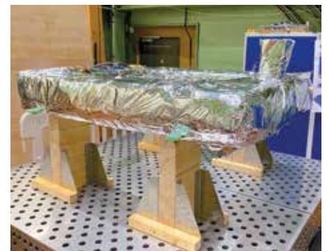
Abb. 3: In das Kühlschild eingebaute Spule und Stromzuführung.
