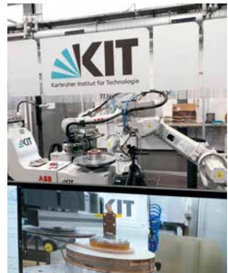
Abb. 5: Robotisches Wickeln des HTS-Magneten für das MEESSST-Projekt.
