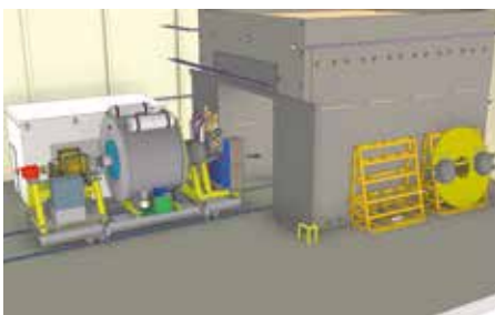
Abb. 12: Aufbauskitze HTS-Geno Testrig.
