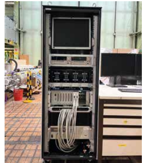
Abb. 8: Mobiles Messrack für den Abnahmetest der Quench-Probe.
