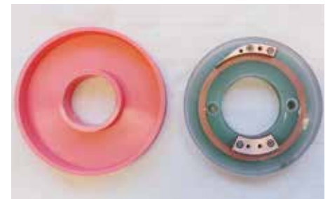
Abb. 1: Vergossene HTS Pancake-Wicklung (rechts) mit Vergussform (links).
