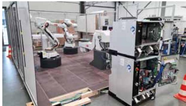
**Abb. 1: Fortgeschrittener Aufbau der Roboterzelle mit zwei Robotern, Positioniertisch und teilaufgebauter Schutzumhausung. Im Vordergrund ist die Steuerungselektronik der Roboter zu sehen.**
