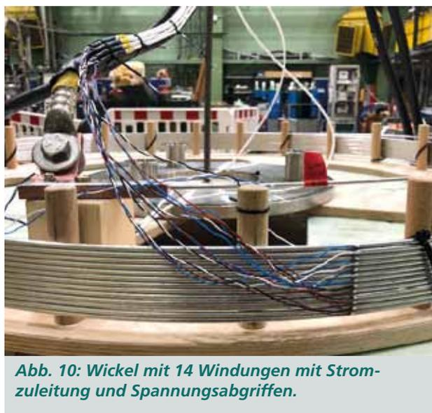
Abb. 10: Wickel mit 14 Windungen mit Stromzuleitung und Spannungsabgriffen.
