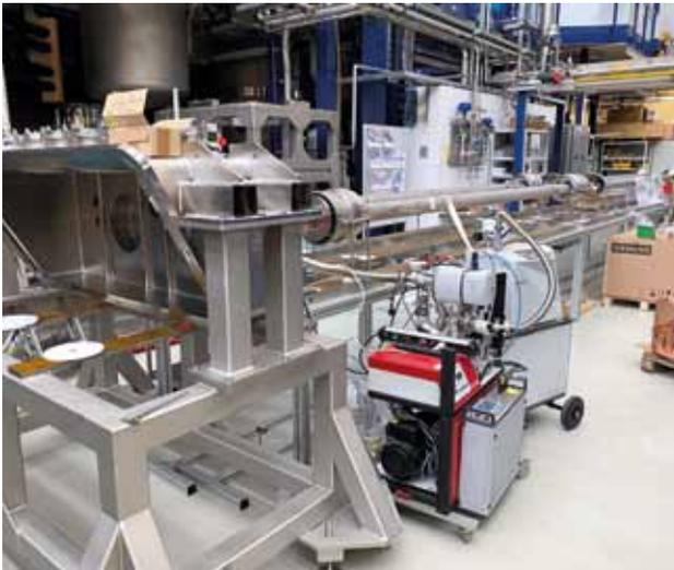
Abb. 2: Aufbau der Ventilbox und des Kryodemonstrators für eine 20-K-Hochstromleitung mit Hochtemperatur-Supraleitern.
