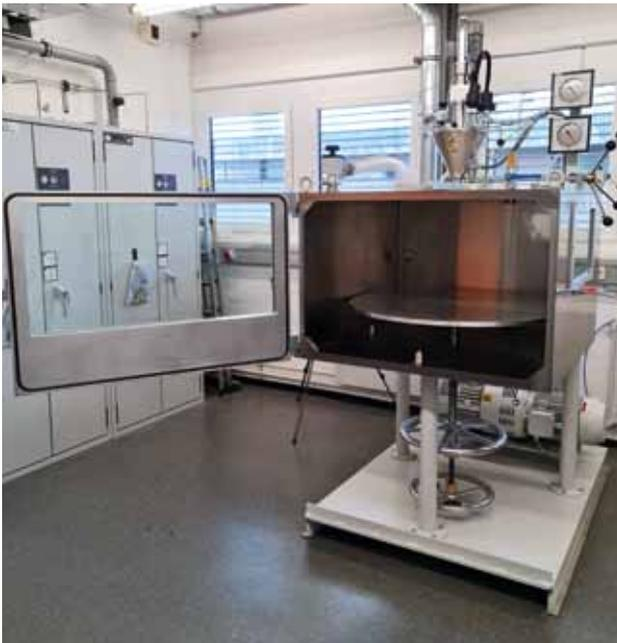
Abb. 3: Neu beschaffte Vakuum-Druck-Imprägnier-Anlage.
