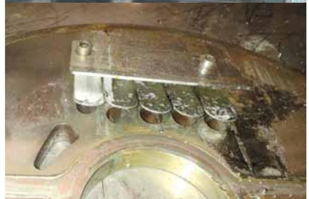
Abb. 10: Zerlegung der Quecksilberringpumpe.
