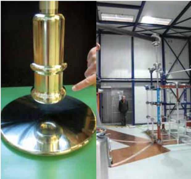
Abb. 4: Glocke-Platte-Anordnung zur Untersuchung des Durchschlagverhaltens in flüssigem Stickstoff (oben), Aufbau; des Testkryostaten im kryogenen Hochspannungslabor des ITEP (unten).
