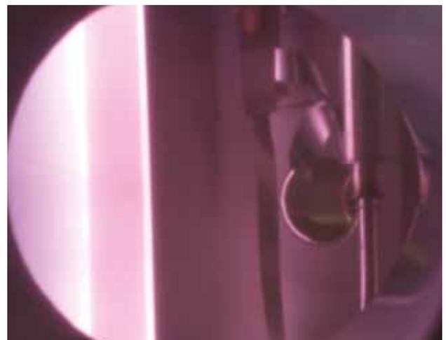
Abb. 2: Blick in die Vakuumkammer von HERMESplus. Auf der linken Seite ist das leuchtende Wasserstoffplasma um die Plasmaquelle zu sehen, auf der rechten Seite sind weitere Einbauten erkennbar, unter anderem die zu einem Zylinder geformte Metallfolie.
