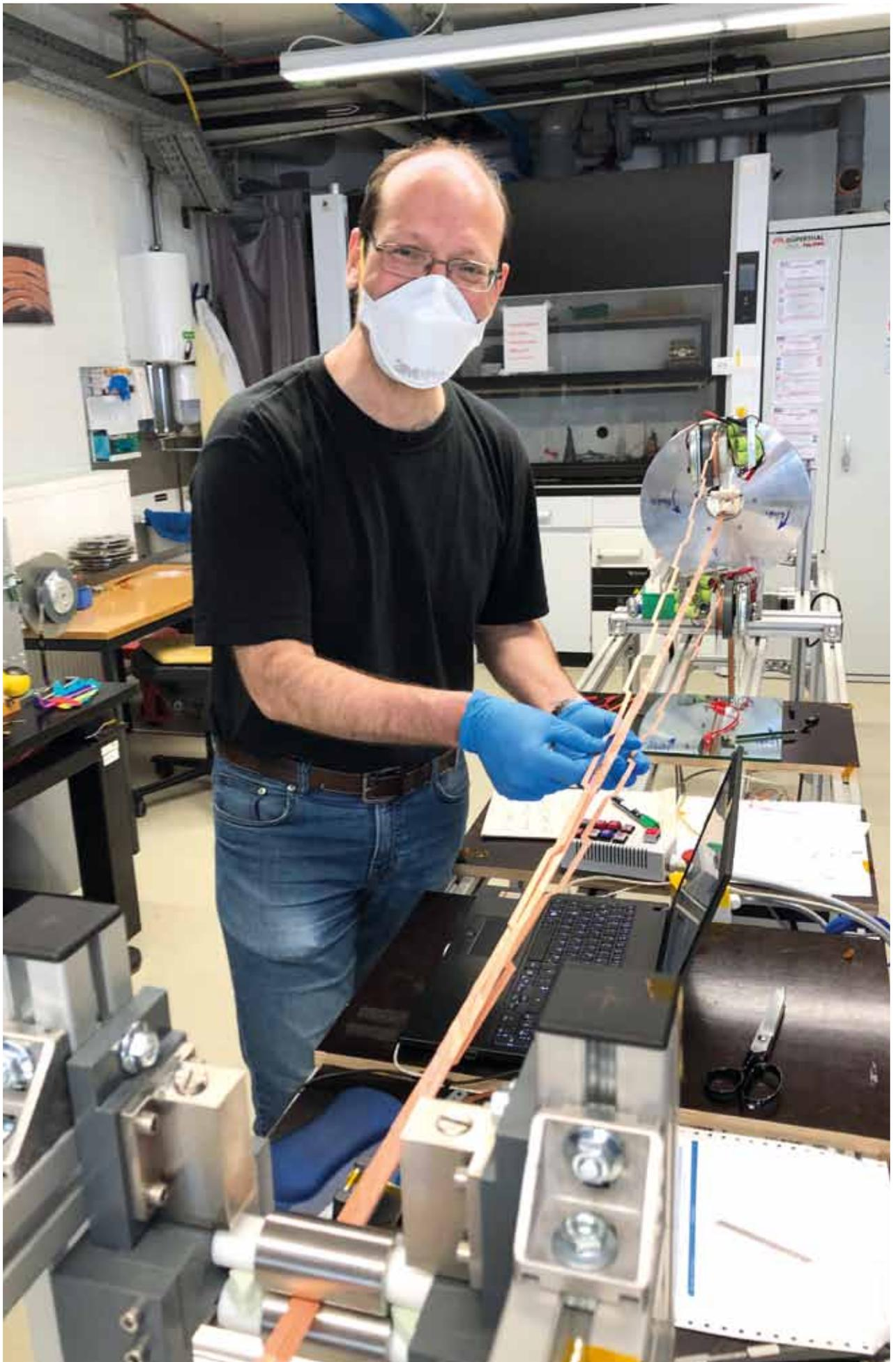
*Herstellung von verlustarmen Hochstrom ROEBEL-Kabeln aus HTSL-Bandleitern im Rahmen einer KIT-CERN Forschungskooperation zur Entwicklung von HTSL-Dipolmagneten*
