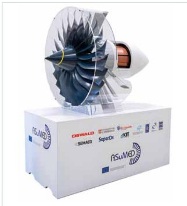
**Abb. 14: Motor mit Gondel und Fan für Verkehrsflugzeuge mit verteilten Antrieben (1 MW, 6000 Upm, 1:1 Mockup).**
