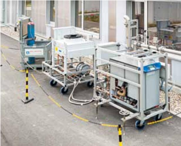
**Abb. 9: Versuchsaufbau der Mikrogasturbine**
