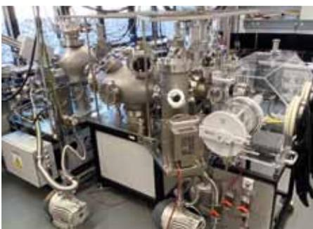
**Abb. 8: UHV-Depositions-Cluster mit PLD, Sputtern, Ar-Box und Proben-speicher.**
