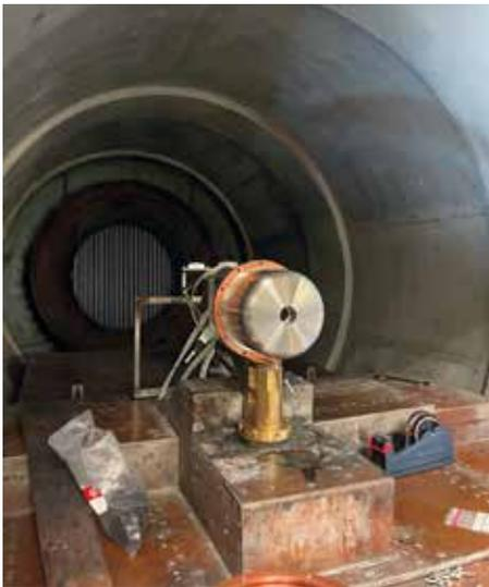
**Abb. 5: MEESST-Magnet und Kryostat während der Installation im PWK1-Plasmakanal des IRS.**
