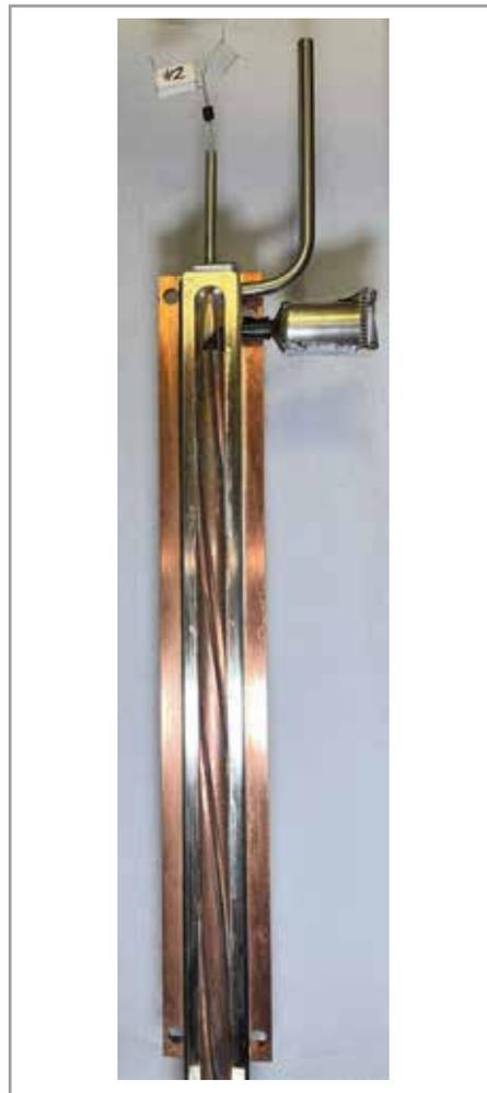
**Abb. 9: Foto des Stands der Reparatur Ende 2024. Nachfolgend müssen die Drähte (oben) entfernt und durch Glasfasern ersetzt werden. Die Drähte dienen zur Vermeidung einer Verunreinigung der Kapillaren.**
