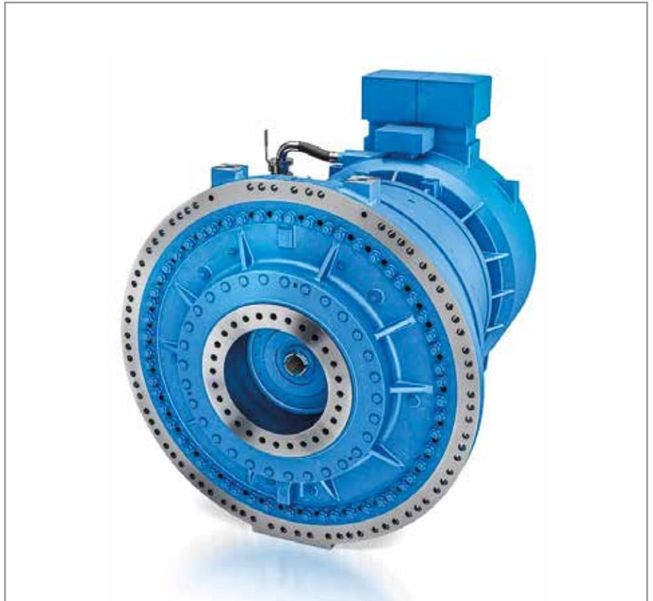
**Abbildung 17: Antriebsseite (Getriebeseite) eines mittelschnell laufenden Windkraftgenerators mit zentraler Durchführung für die Blattverstellung („Pitch-Rohr“) der Windkraftanlage. Dieses Pitch-Rohr muss im finalen Produkt auch durch einen HTS-Rotor durchgeführt werden können – die Erfindung erlaubt das. Das Bild zeigt das Gehäuse der konventionellen Maschine (Fa. Flender/Winergy).**
