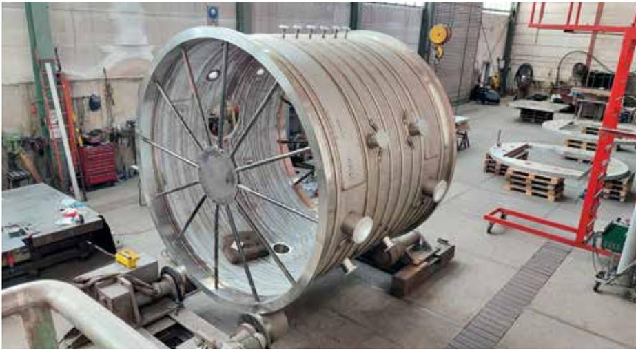
Abb. 10: Aufnahme aus der Fertigung des Mittelteils des zentralen Vakuumbehälters.
