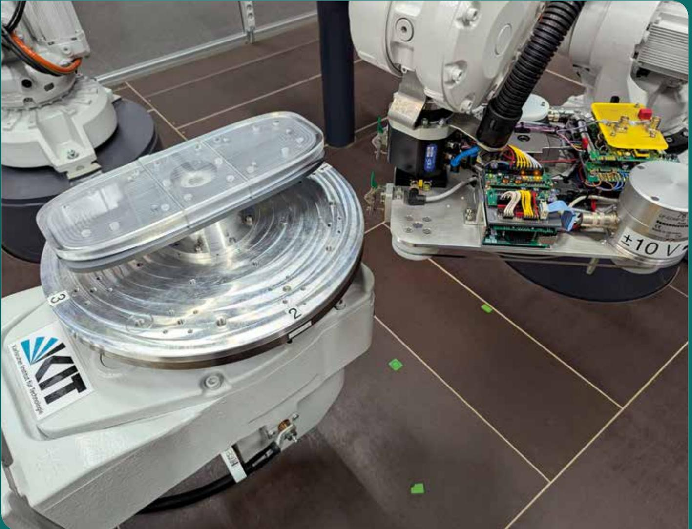
Wickelversuche in der robotischen Wickelzelle zur Herstellung von nicht planaren Spulen aus der zweiten Generation von Hochtemperatursupraleiter-Bändern (2G-HTS). Die besondere Herausforderung ist die degradationsfreie Führung über die hohe Kante der Bänder mit einem hohen geometrischen Aspektverhältnis.
