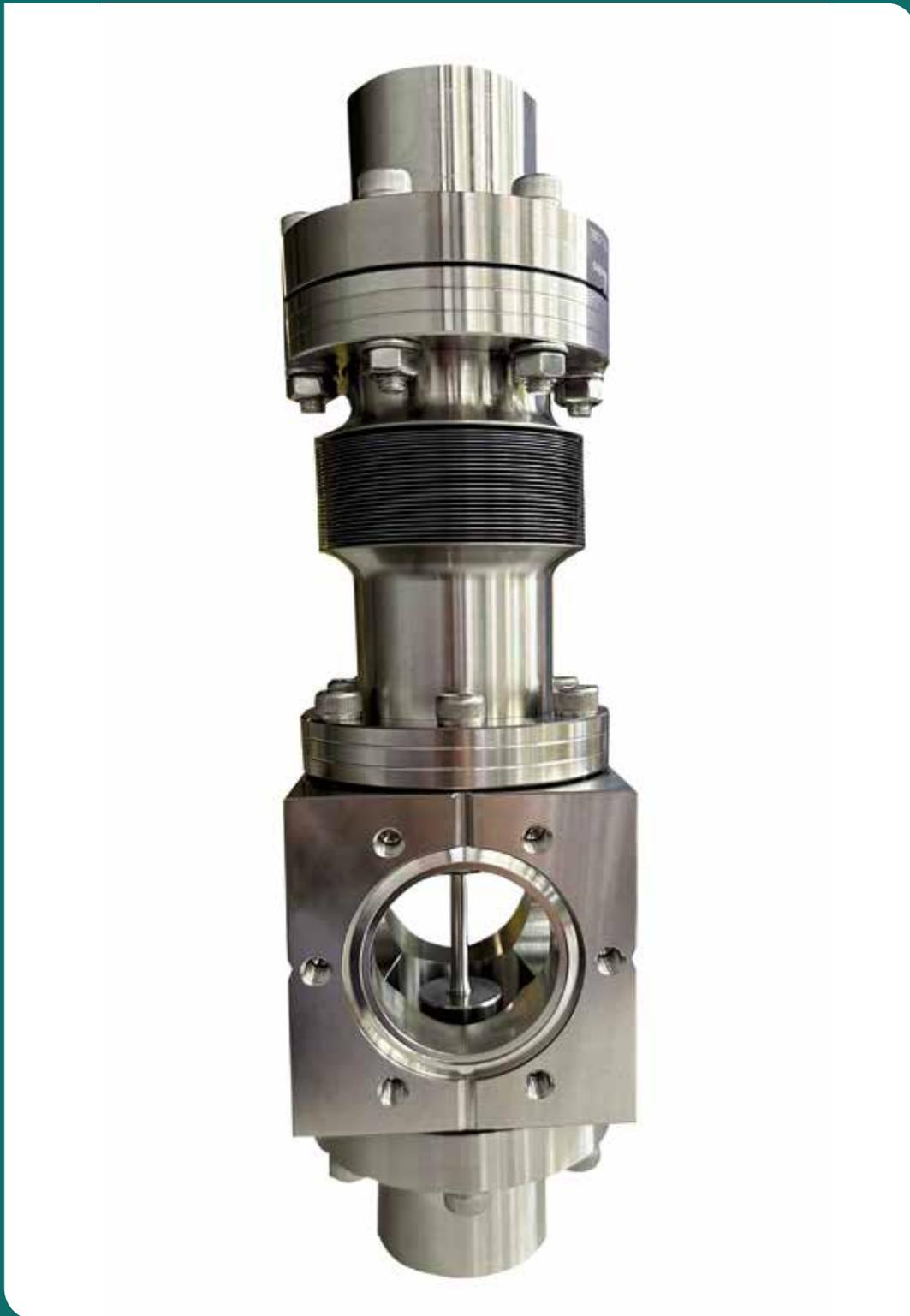
Testkammer für mechanische Zug- oder Bruchuntersuchungen in kryogenem Wasserstoff (gasförmig oder flüssig).
