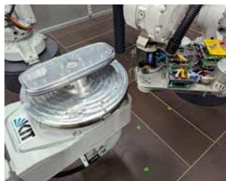
Abb. 1: Testwicklung einer Spule mit aufgestellten Wickelköpfen auf einem superellipsenförmigen Wickelkörper.
