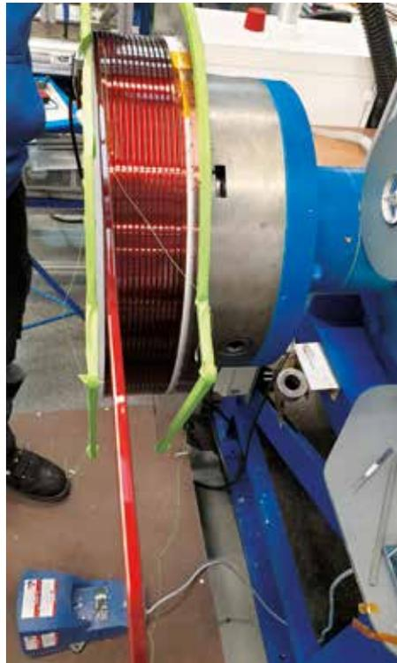
**Abb. 4: Herstellung der Magnetspulen für HERMESloom am ITEP.**
