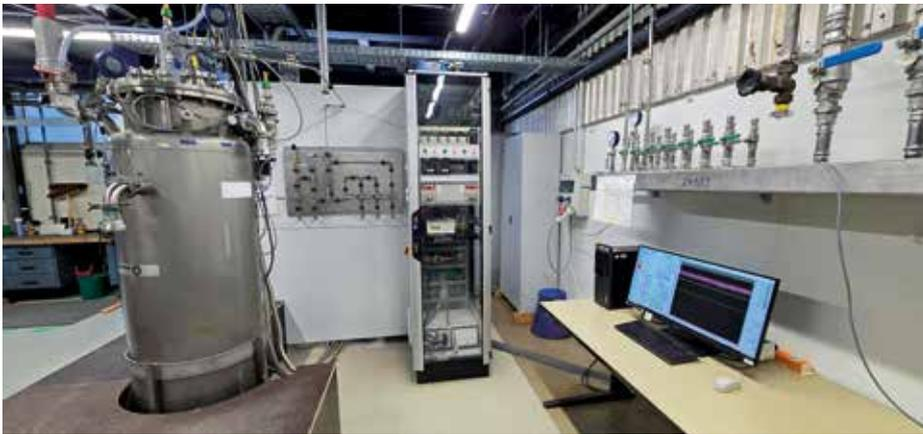
Abb. 2: Thermosiphon-Teststand mit Kryostat und Kryokühler (links), Messrack (Mitte) und PC mit Lab-View-Messprogramm (rechts).
