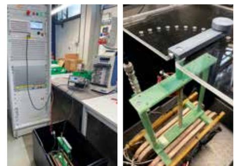
Abb. 16: Aufbau zur winkelabhängigen AC-Magnetisierungsmessung an DUDA-Spulen.
