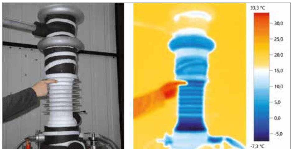
Abb. 5: RIS-Durchführung in optischer (links) und thermografischer Darstellung (rechts). Die tiefste Temperatur beträgt  $-7,3\text{ }^{\circ}\text{C}$ .
