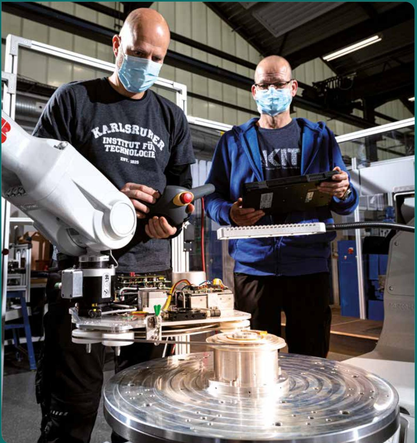
Robotisches Wickeln einer einfachen Pancake-Spule: Der Wickelkörper wird von einem Zwei-Achs-Positionierroboter gehalten. Die Wickelhand befindet sich am Wechselwerkzeug eines der beiden Sechs-Achs-Roboter – auf dem Foto noch mit einem für HTS repräsentativen Stahlband zur prinzipiellen Prozessqualifizierung.
