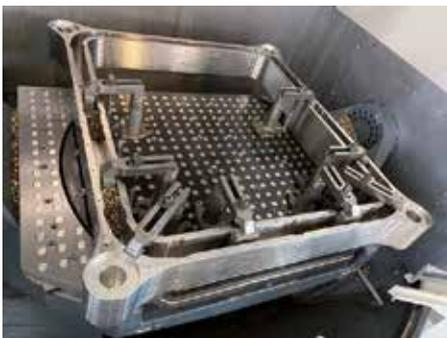
Abb. 3: Die Spulenhalterung bei der Fertigung.
