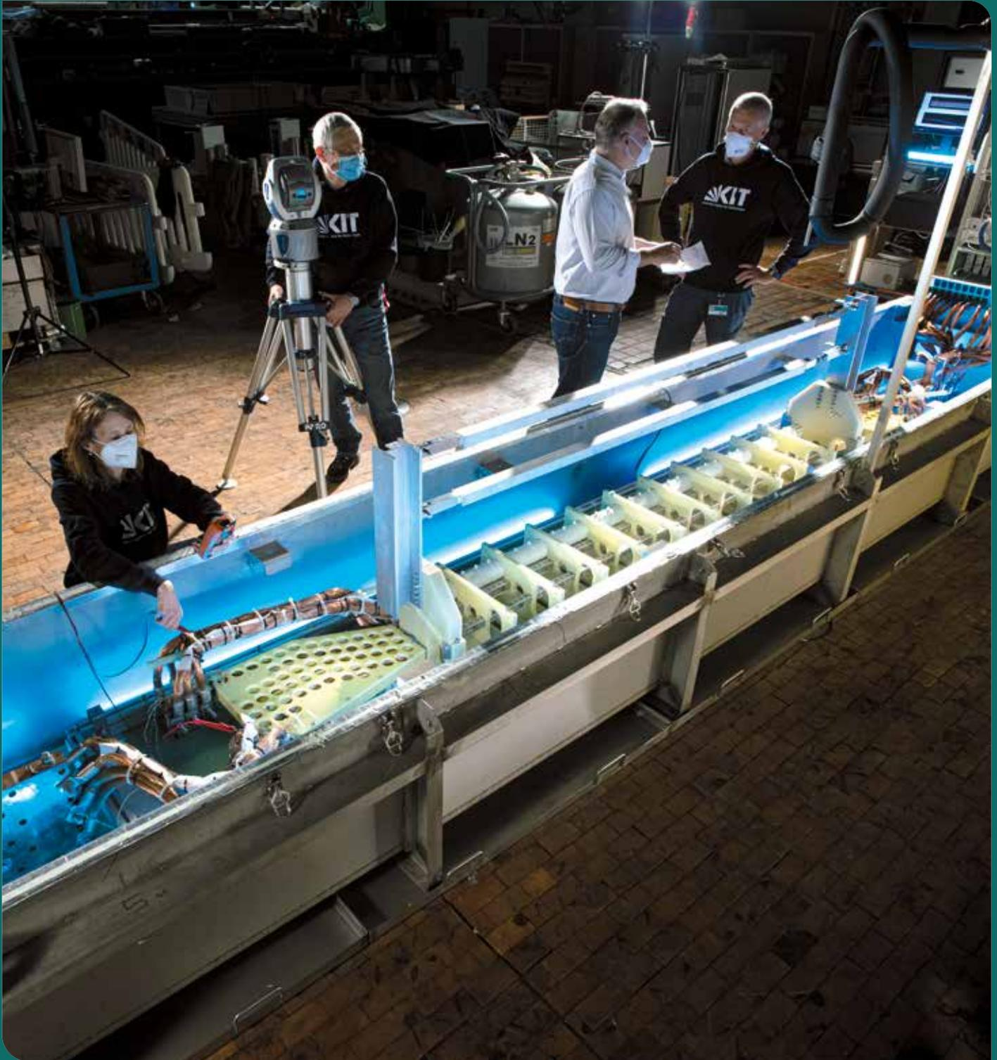
Testaufbau von zwei 20 kA-Teilleitern für eine
