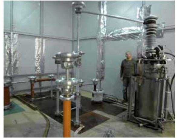
Abb. 4: RIS-Durchführung außerhalb des Kryostaten (links) und in eingebautem Zustand (rechts) mit Aufbau zur Schering-Brücken-Messung.
