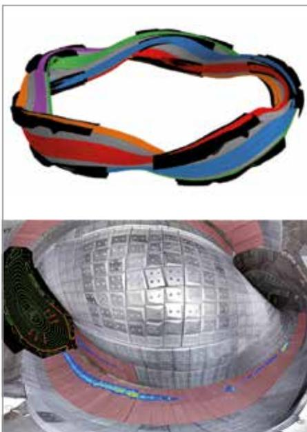
Abb. 8: Veranschaulichung der zu modellierenden Flächen im Plasmagefäß von W7-X.
