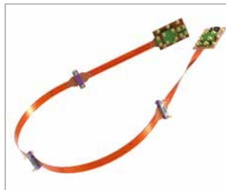
Abb. 8. Design der ESA HTS-Stromzuführung für Sub-Kelvin-Kühler auf Satelliten.
