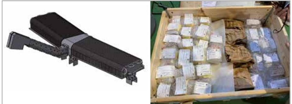
Abb. 1: Design der Kryopumpe für JT-60SA (links) und erste Komponenten in der Herstellung (rechts).
