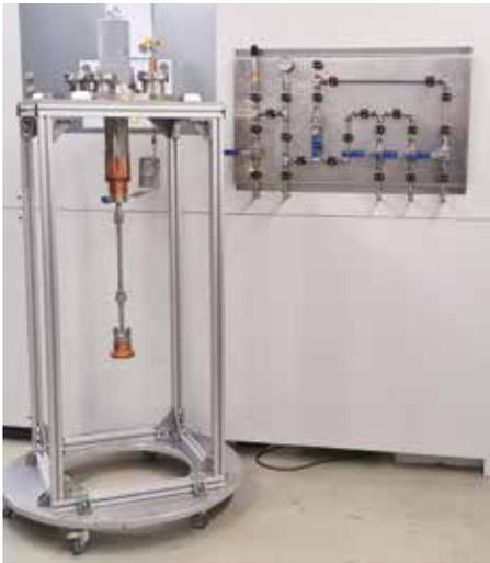
**Abb. 4: Begonnener Aufbau des Thermosiphon-Teststands. Links ist der Kryostateinsatz mit Kaltkopf und Thermosiphon zu sehen, rechts das Bedienpanel der Verrohrung der Anlage.**
