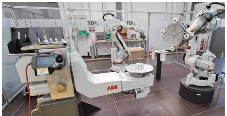
Abb. 1: Zelle zum robotischen Wickeln mit Werkstückpositionierer (links) und den beiden Robotern. Der Roboter rechts trägt die Wickelhand mit der Vorratsspule.
