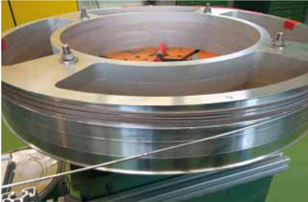
Abb. 9: Fertigung von HTS CroCos im Rolle-zu-Rolle-Verfahren.
