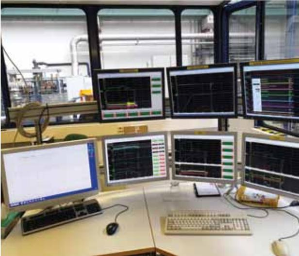
Abb. 17: Neu aufgebautes Kontrollsystem zur Magnetüberwachung mit Quenchdetektion für die drei unabhängigen Stromkreise der NbTi-, NbSn- und HTS-Magnet-Teilsysteme.
