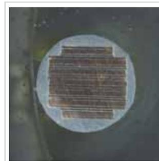
**Abb. 8: Schliffbild eines HTS CroCos aus 2 mm und 3 mm breiten Bändern. Die Kreuzgeometrie und die runde Lothülle sind nahezu perfekt ausgebildet.**
