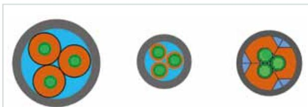
Abb. 4: Schematische Darstellung dreier CroCo-Konzepte für ein Quenchexperiment in SULTAN: Referenzdesign (links), Design mit geringem Kupferanteil (Mitte) und Design mit Kupferprofilen (rechts).
