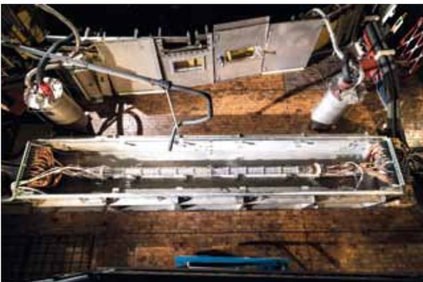
Abb. 3: Aufbau eines 35 kA DC Kabeldemonstrators mit 12 einzelnen CrossConductor Leitern
