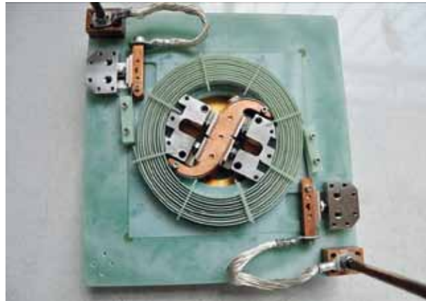
Abb. 7: Testkomponente eines HTS-Strombegrenzers aus Coated Conductor.
