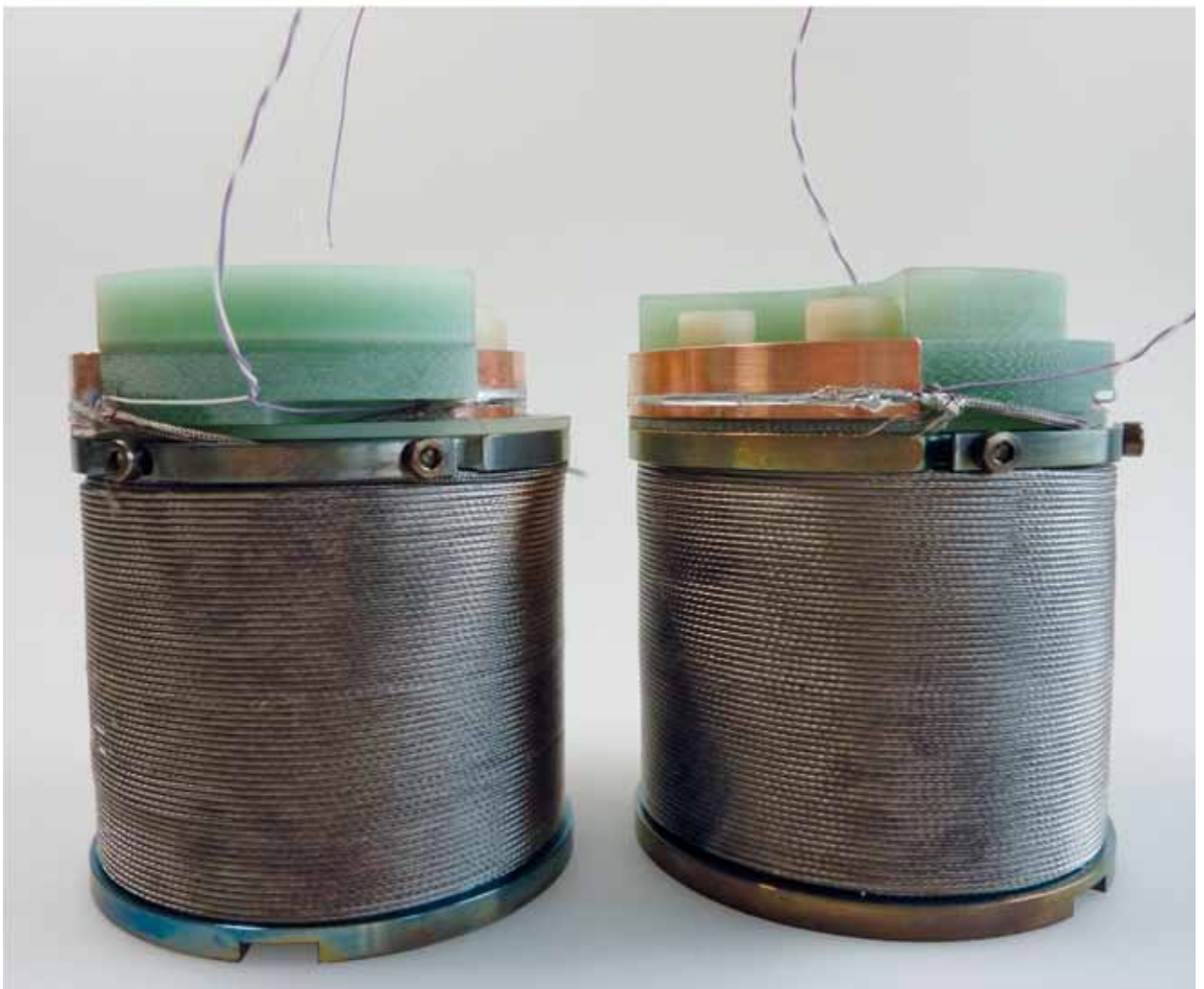
Feldberechnung für eine MgB 2 -Spule (links oben), Herstellung der Spule (rechts oben) und geglähte Spulen vor dem Vergießen mit Wachs (unten).
