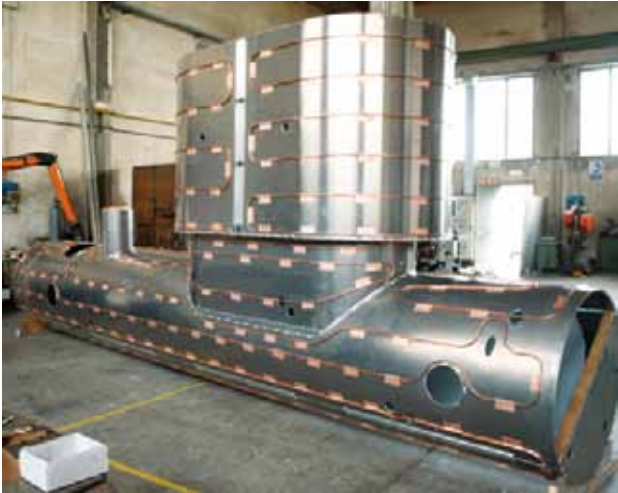
Abb. 5: Thermisches Schild der CPS. In der Mitte des mehr als sieben Meter langen Systems ist der große Turm zu erkennen, der später den großen LHe-Behälter aufnehmen wird.
