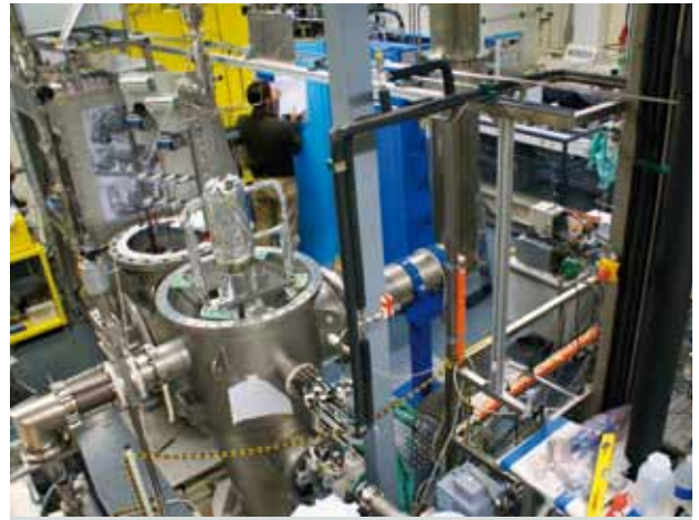
Abb. 4: Blick auf die TRENTA Anlage: Im Vordergrund links ist die geöffnete Kryokolonne zu sehen. Die schwarze Kolonne am rechten Bildrand gehört zur WDS. Bei dem blauen Gerät im Hintergrund handelt es sich um die Linde-Kälteanlage für die ISS.
