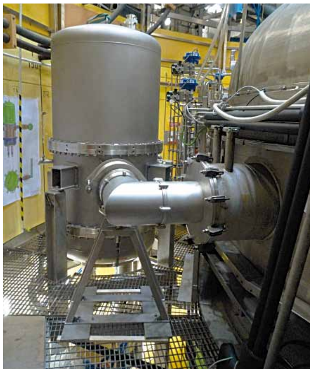
Abb. 3: Testkryostat mit Prototypstromzuführungen im Test.
