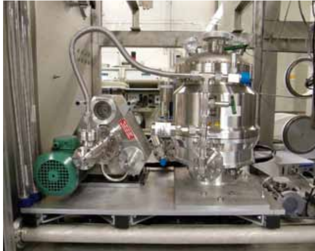
Abb. 6: TRITOP Experiment im Aufbau. Zu sehen sind die beiden beteiligten Pumpen – links Normtex („Dreieck“) und rechts die MAG2800-Turbo-pumpe.
