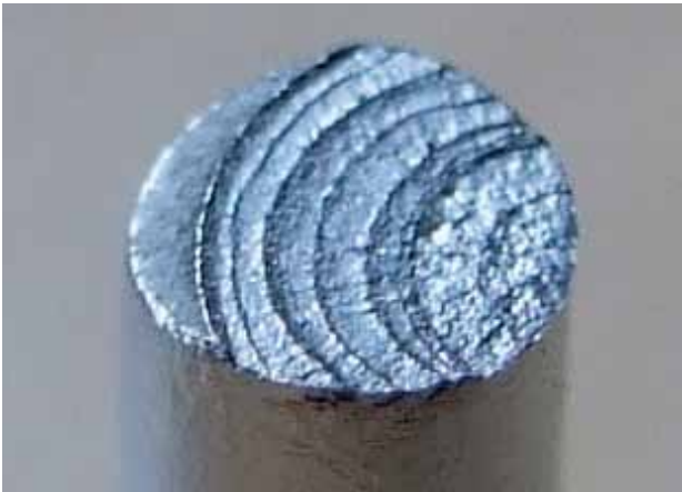
Abb. 9: Bruchfläche mit \varnothing 4 mm einer Ermüdungsprobe aus PF Hüllmaterial, nach rund 25 000 Zyklen bei einer Belastungsamplitude von 100 MPa bis 1100 MPa bei 4.2 K.
