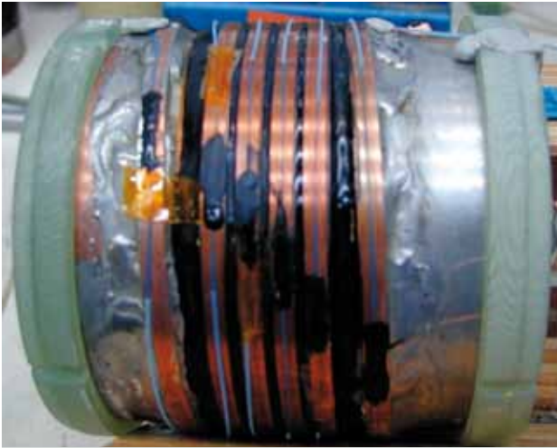
Abb. 5: NbTi-Test-Spule mit FBG-Sensoren.
