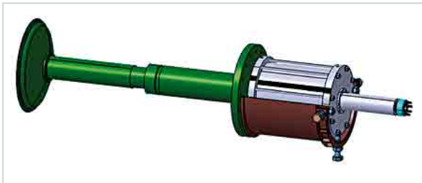
Abb. 3: Design des Antriebs für das Pumpeneinlassventil.
