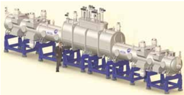
Abb. 2: WGTS Magnetkryostat. Der 16 Meter lange Kryostat ist technisch äußerst komplex aufgebaut und muss hohe technologische Anforderungen erfüllen. Das System hat zwölf kryogene Kreisläufe; es werden sechs verschiedene Fluide (He, Ne, N_2 , Ar, T_2 und Kr) eingesetzt.
