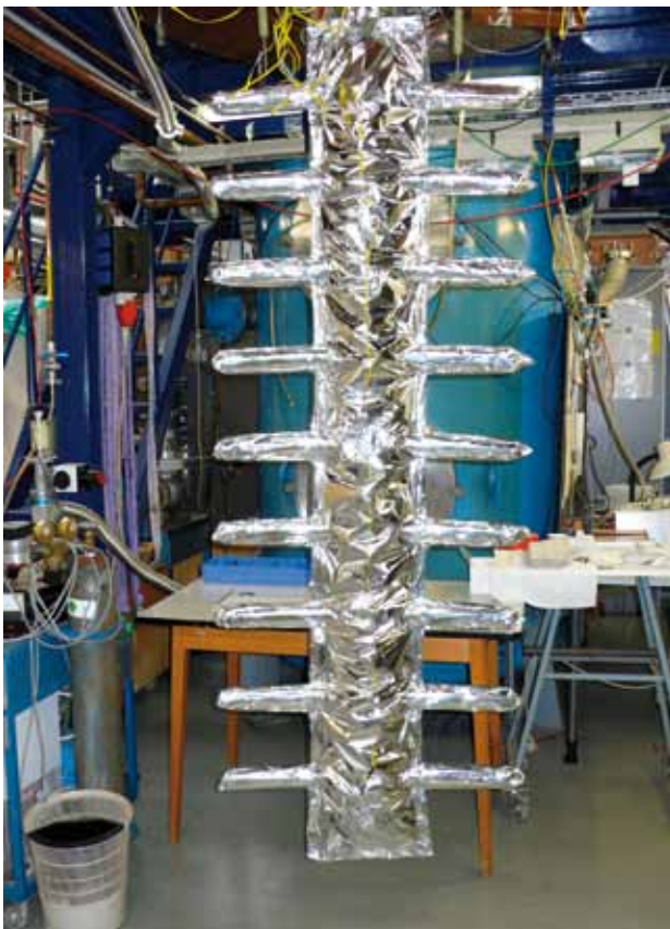
Abb. 4: Isolierter Behälter mit T-Stücken.
