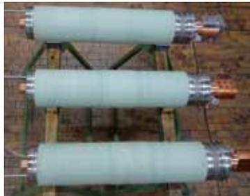
Abb. 2: Wärmetauscher mit isoliertem Hüllrohr.
