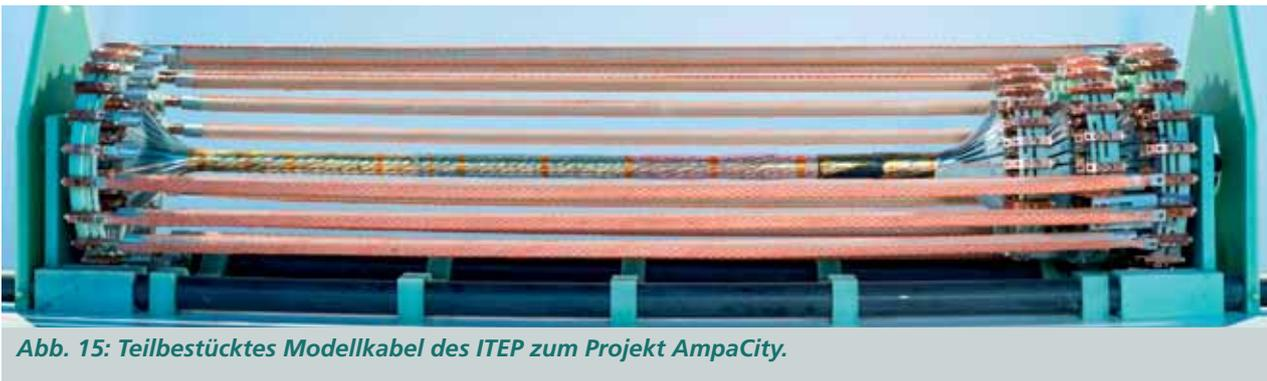
Abb. 15: Teilbestücktes Modellkabel des ITEP zum Projekt AmpaCity.
