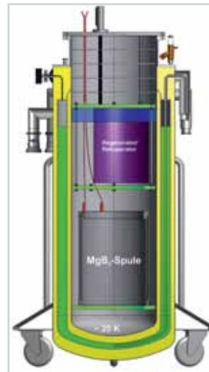
Abb. 6: Kryostat mit SMES ( $MgB_2$ -Spule) und Regenerator/Rekuperator-Einheit.
