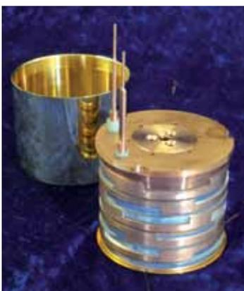
**Abb. 7: Magnet aus HTS-Bandleitern aus fünf Doppelpancake-Wicklungen vor Anbringung der Lötkontakte mit 5 T Zentralfeld.**
