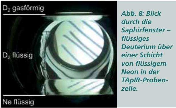
Abb. 8: Blick durch die Saphirfenster – flüssiges Deuterium über einer Schicht von flüssigem Neon in der TApIR-Probenzelle.
