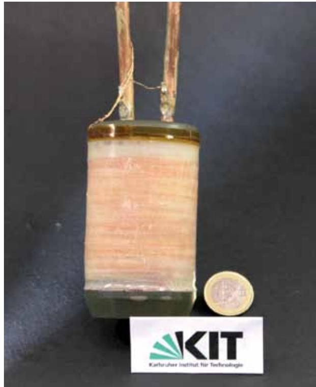
**Abb. 8:** 1T-REBCO-Mini-Solenoid für die HOMER I-20 T Konfiguration.
