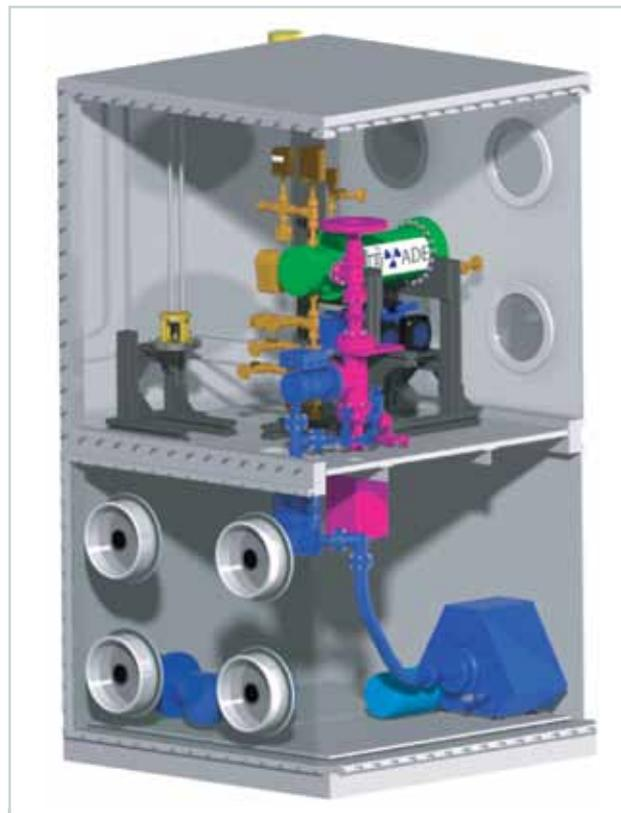
Abb. 10: CAD des TriADE-Abzugs mit Pumpstand (blau markiert), Kernkomponenten (grün), Instrumentierung und Handventilen (braun), Massenspektrometer und zugehörigem Volumen (magenta) sowie Probenhalter (gelb).
