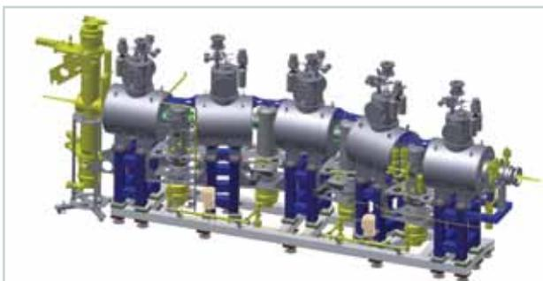
Abb. 3: Neues Konzept für die differenzielle Pumpstrecke von KATRIN. Zu sehen sind die fünf supra-leitenden Magnete sowie die fünf Pumpkammern.
