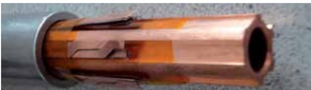
Abb. 3: Rutherford-Kabelkonzept mit sechs Roebel-Strands in hexagonaler Anordnung und Hüllrohr zur mechanischen Verstärkung.
