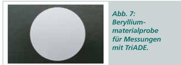
Abb. 7: Berylliummaterialprobe für Messungen mit TriADE.
