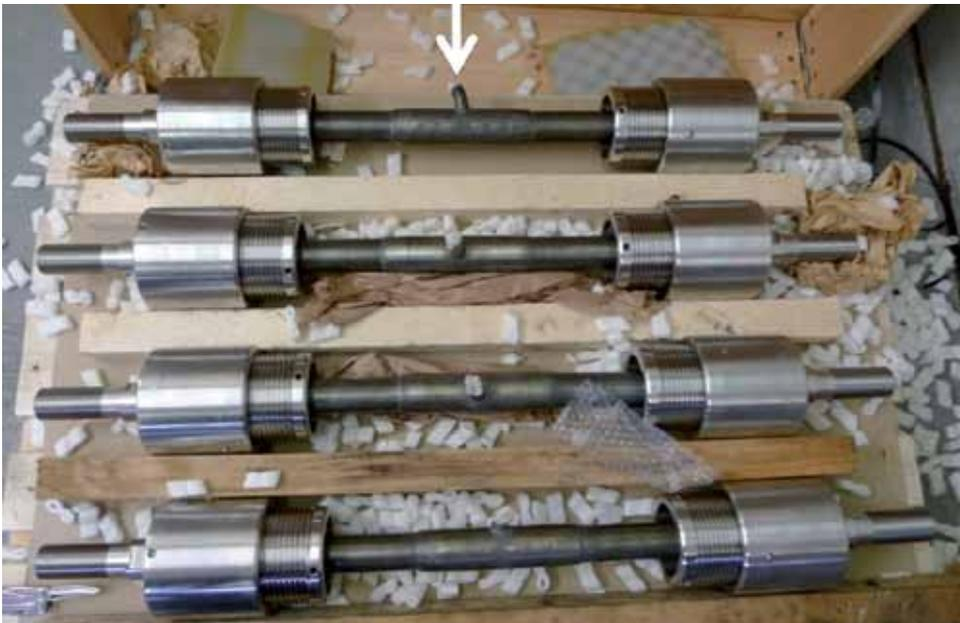
*Abb. 11: Vier europäische Prototypen der He-Inlets für die ITER TF-Spulen mit einer Länge von je etwa 1,2 m. Außen die Klammern zum Montieren der Komponente in der Testeinrichtung, in der Mitte (siehe Pfeil) das eingeschweißte Rohrstück für den Helium-Einlass.*
