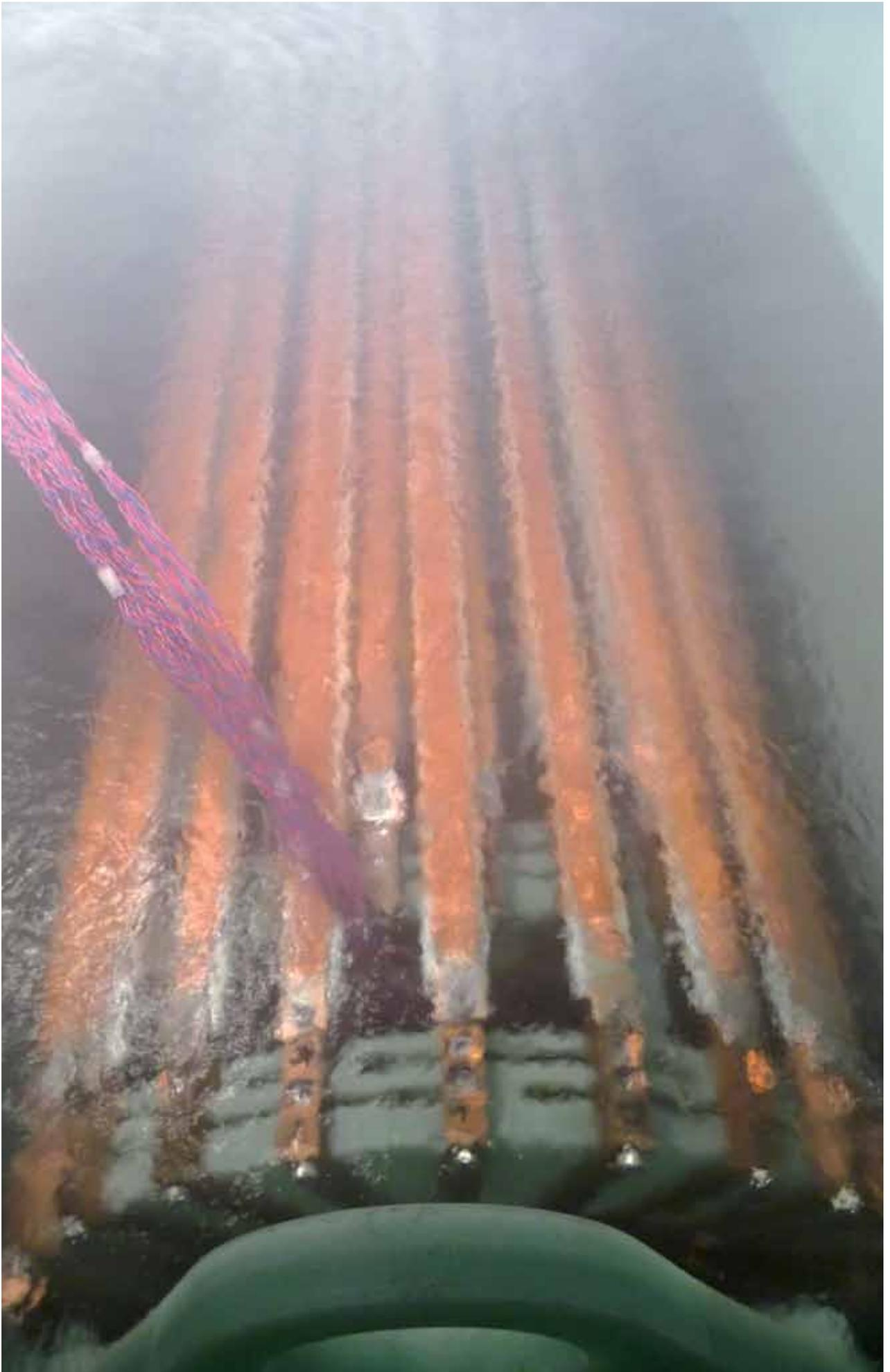
Modell des Energiekabels im Flüssigstickstoffbad
