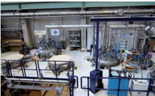
Abb. 1: Stromzuführungstestanlage CuLTKa.
