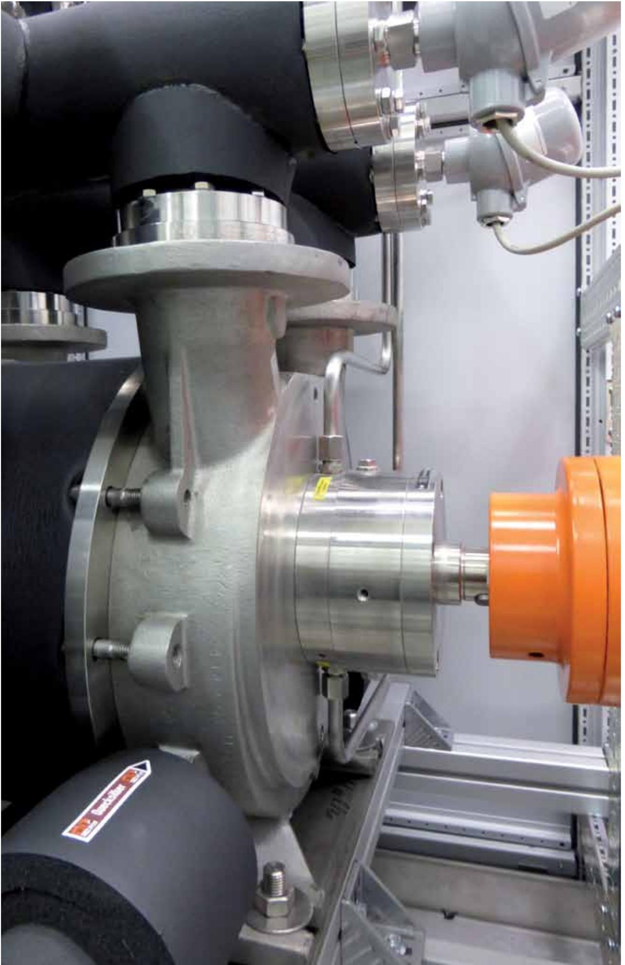
Die weltweit erste Quecksilber-Flüssigkeitsring-Vakuumpumpe im Betrieb.
