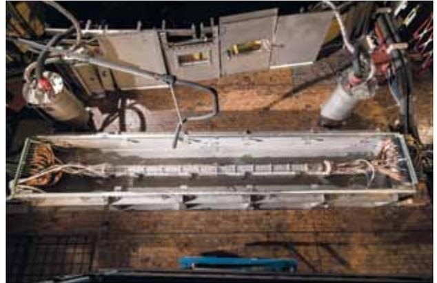
Abb. 12: Testaufbau für das SupraDCKabel.
