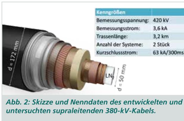
Abb. 2: Skizze und Nenndaten des entwickelten und untersuchten supraleitenden 380-kV-Kabels.
