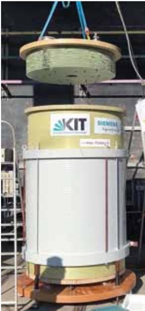
*Abb. 9: 10-MVA-Strombegrenzer SmartCoil beim Aufbau im Leistungslabor von Siemens in Berlin: Außen die Kurzschlussstrombegrenzungs-Drosselspule in Grau, innen der Kryostat, der den Supraleiter beinhaltet, oben der Kryostatdeckel.*
