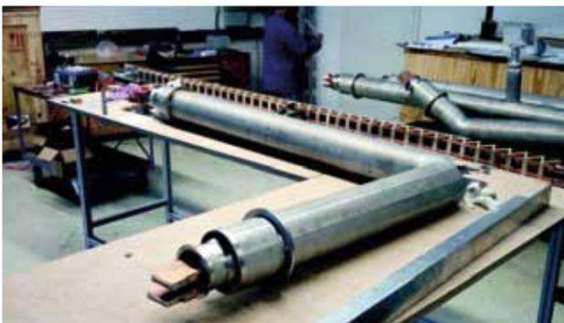
**Abb. 1: Winkelstück einer 20 kA supraleitenden Hochstromschiene. (Foto: Vision Electric Superconductors)**
