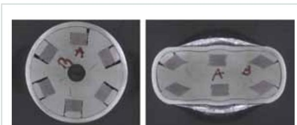
Abb. 7: Querschnittsbild des supraleitenden Hochstromkabels ( $\varnothing$  25 mm) vor und nach der transversalen Verformung bei 77 K.
