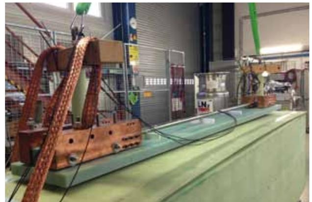
Abb. 3: Mit Cu-Bändern bestücktes Dummy-Kabel für den Lorentzkräftetest vor dem Einbau in den Kryostaten.
