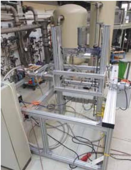
**Abb. 11:** Rotations-teststand zur Untersuchung der Effizienzänderung von Kleinkühlern unter Rotationsbedingungen
