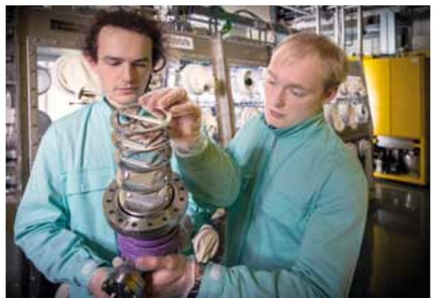
**Abb. 3:** Beladungsvorrichtung mit Probenhalter zur Vorauswahl von Materialien für anschließende Untersuchungen mit BIXS.
