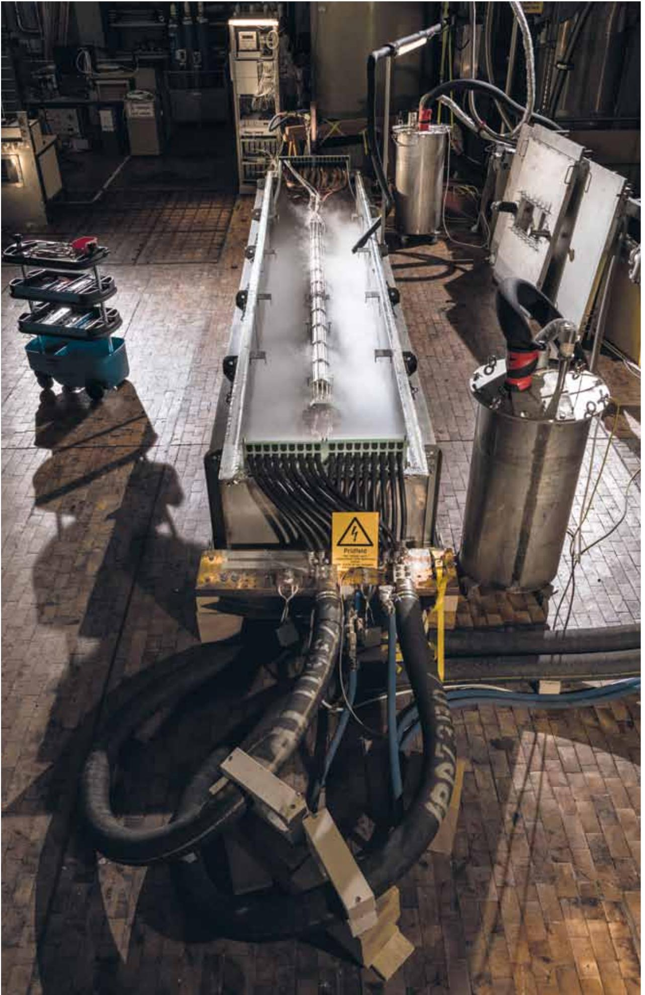
*Demonstrator eines supraleitenden 35 kA DC Kabels aus zwölf HTS CroCos vor dem Abkühlen auf 77 Kelvin*
