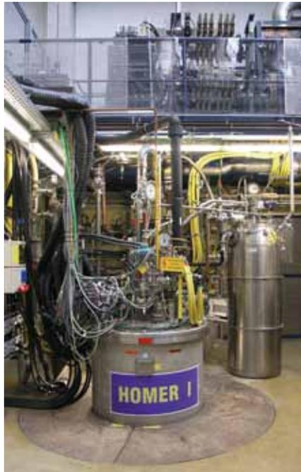
**Abb. 12:** Supraleitende Experimentieranlage HOMER I für Spulentests und Supraleitercharakterisierungen in Hintergrundfeldern von 15 T bzw. 20 T bei Lambda-temperatur  $T = 2,2$  K.
