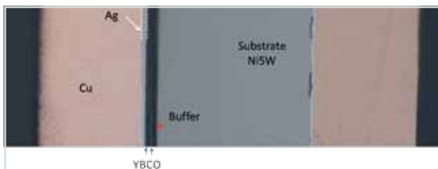
Abb. 2: Querschnitt des Dnano-HTS-Bandleiters im EU-Projekt EUROTAPES.
