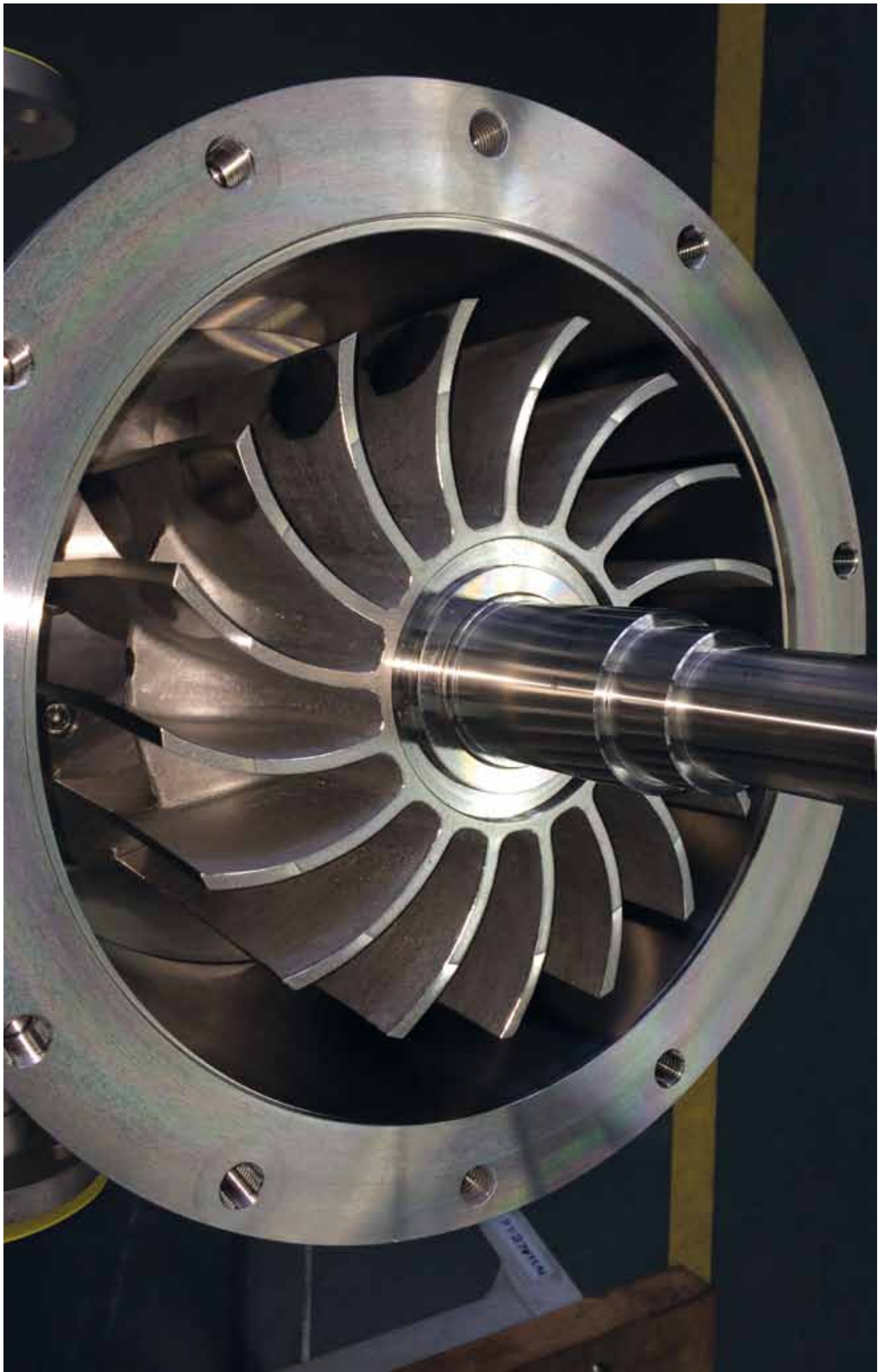
Die erste tritium-kompatible Flüssigkeitsringpumpe beim Zusammenbau in der Herstellerfirma.
