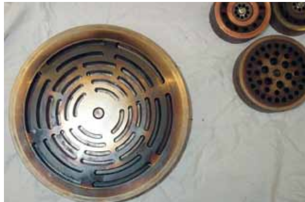
Abb. 2: Ausbau der konzentrischen Ventile des Verdichters V20. Die Revision der Ventile gehört zum 2 000-Stunden-Service.
