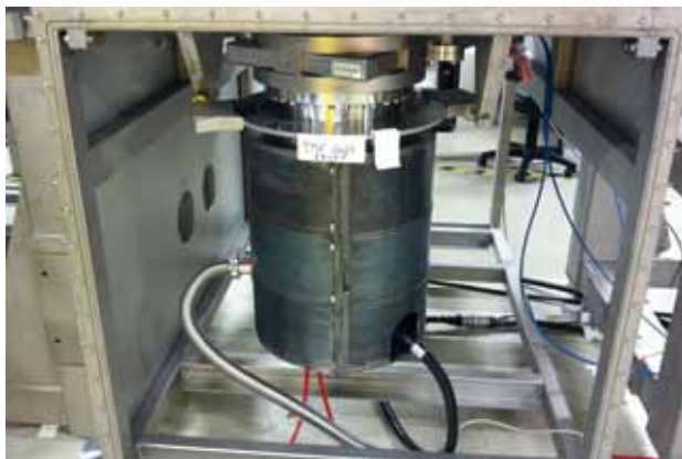
Abb. 5: Turbopumpe des Tritiumkreislaufs mit magnetischer Abschirmung und Crash-Momentabsicherung, bereit zum Ersteinsatz für First-Light-Messung.
