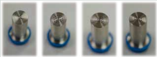
Abb. 4: Vier verschiedene Düsensysteme, die im MNVST-Experiment getestet werden.
