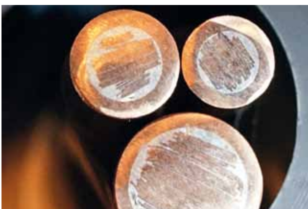
Abb. 1: Schliffbilder von drei HTS CroCos verschiedenen Durchmessers, für die HTS-Bänder unterschiedlicher Breite verwendet werden.
