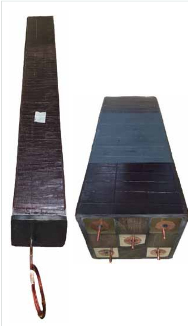
Abb. 10: Langer (links) und kurzer (rechts) PF 3x3 Prüfling, geliefert von ASG für elektrische und mechanische Tests.
