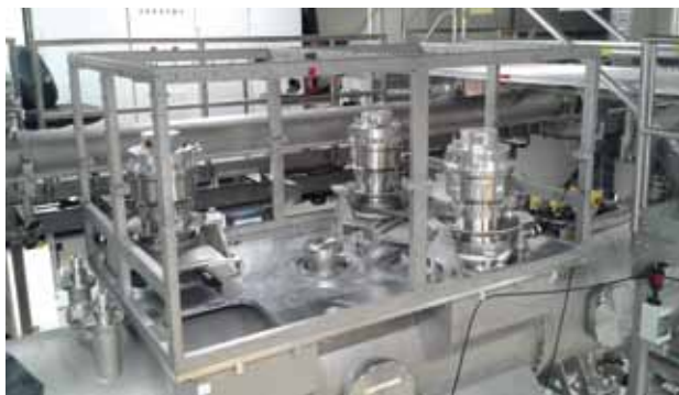
Abb. 4: WGTS-Magnetkryostat mit montierten Ventilen, Crash-Momentabsicherungen, Turbomolekularpumpen und Rahmen der Handschuhbox.
