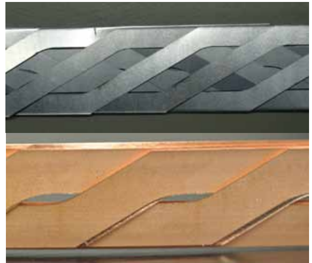
Abb. 11: Verseilschema eines DOCO-Kabels, zur Veranschaulichung mit Teilbestückung der äußeren Kabelschicht (oben) sowie des Standardkabels (unten).
