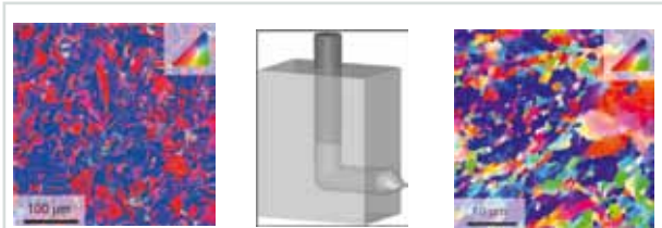
Abb. 8: Nanograins durch extreme plastische Verformung zur Optimierung der mechanischen Eigenschaften in Metallen (links vor, rechts nach der Umformung; das mittlere Bild symbolisiert den ECAP-Umformungsprozess).
