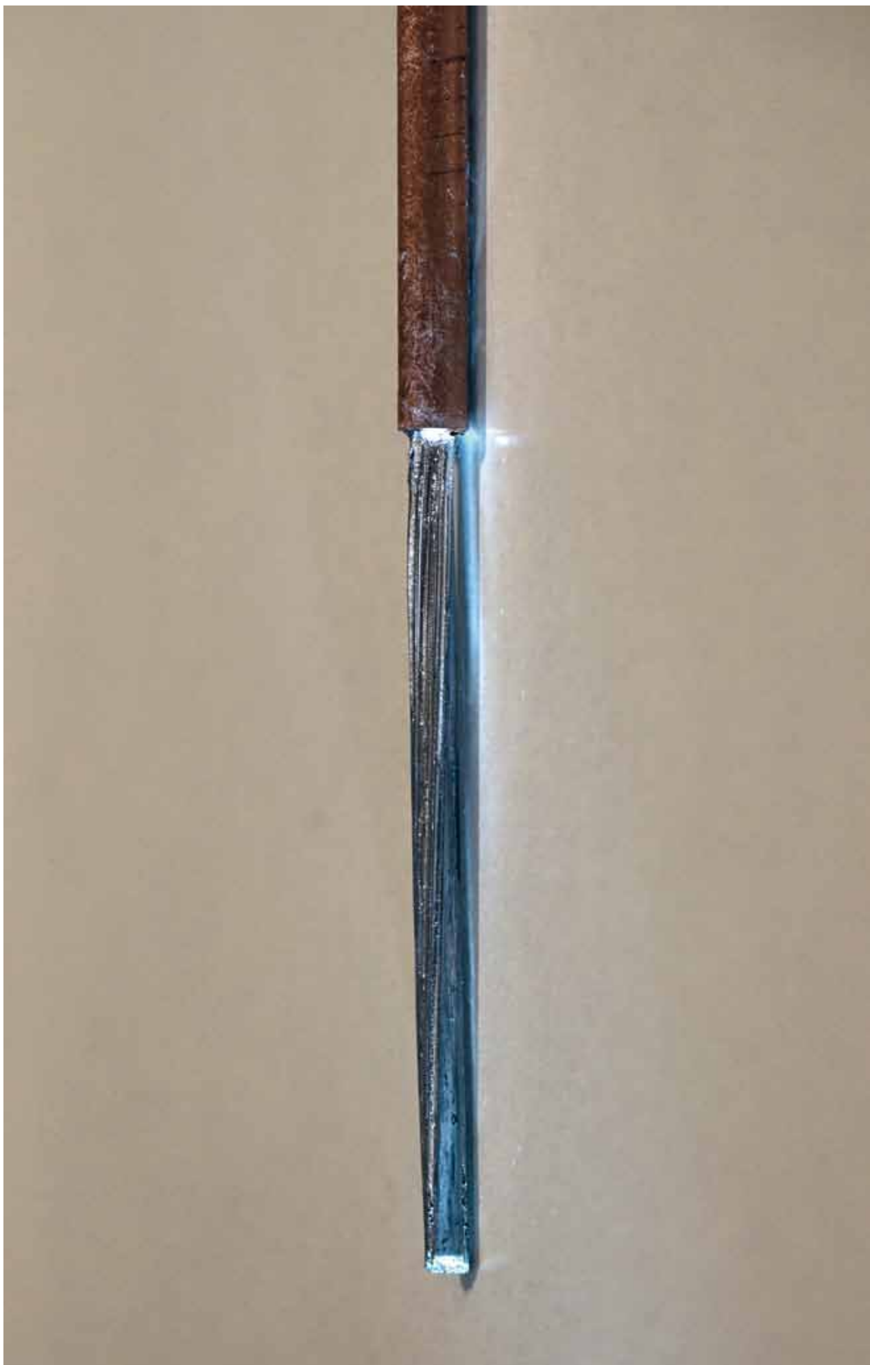
Die hier gezeigte HTS CroCo Version aus 3 und 2 mm breiten REBCO Bändern hat einen Durchmesser von 5,5 mm und eine Stromtragfähigkeit von 1460 Ampere bei 77 Kelvin.
