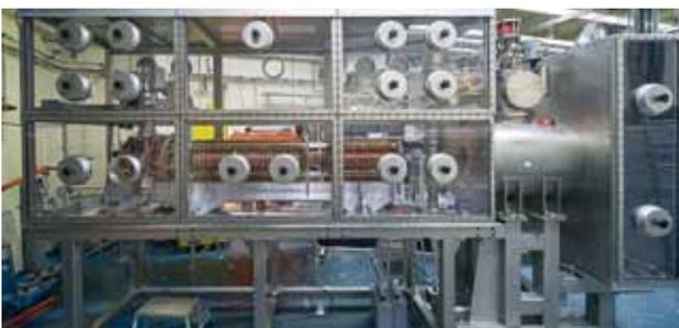
**Abb. 5: Neue Handschuhbox für die Rear Section mit supraleitenden und normalleitenden Magneten. Rechts wird die Tritiumquelle WGTS von KATRIN angeschlossen. Die Elektronenkanone ist links als Teil des primären Vakuumsystems eingebaut.**
