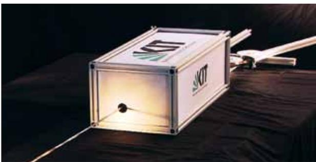
Abb. 1: Laboraufbau zur Herstellung des Supraleiterkörpers des CroCo in einem kontinuierlichen Ein-Schritt-Prozess.
