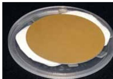
**Abb. 11:** Berylliumprobe mit einer Dicke von  $200\ \mu\text{m}$  und einer aufgetragenen Goldschicht von  $100\ \text{nm}$ .
