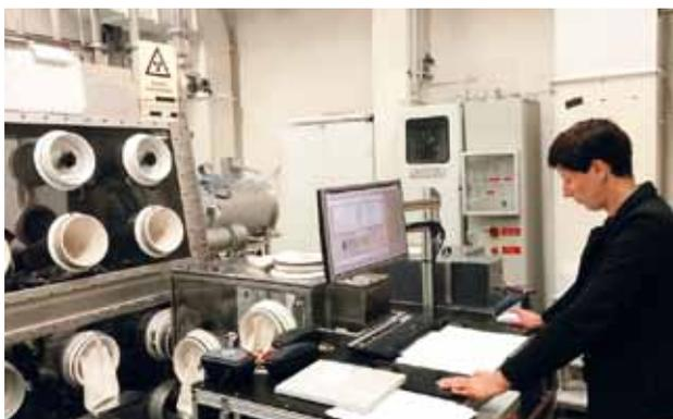
Abb. 2: Tritiumkonzentrationsmessung am TTS mittels der Laser-Raman-Spektroskopie.
