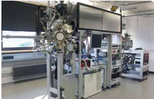
Abb. 1: Labor für die gepulste Laserdeposition. Zwei Vakuumkammern stehen für Hochtemperatur-Supraleiter und eisenbasierte Supraleiter zur Verfügung.
