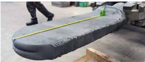
Abb. 10: 316L-Schmiedestück bei COMTES zur Probenherstellung für kryogene Materialtests in CryoMaK.
