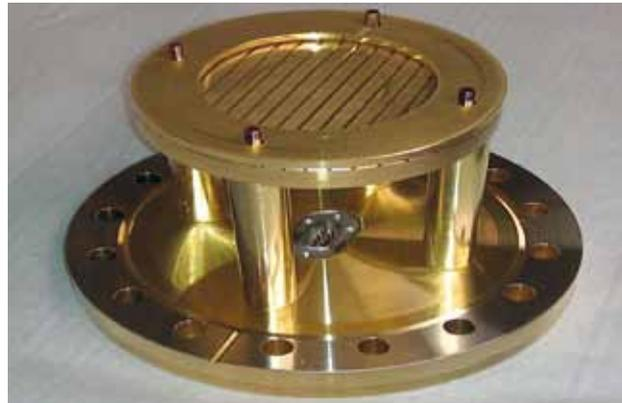
**Abb. 9:** Goldbeschichteter Probenhalter des TRIADE Experiments.
