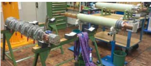
**Abb. 7:** 20-kA-Stromzuführungen während des Zusammenbaus.
