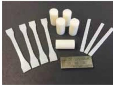
Abb. 11: Im 3D-Druckverfahren hergestellte Zug- und Druckproben sowie Proben für die thermische Ausdehnung (von links nach rechts).
