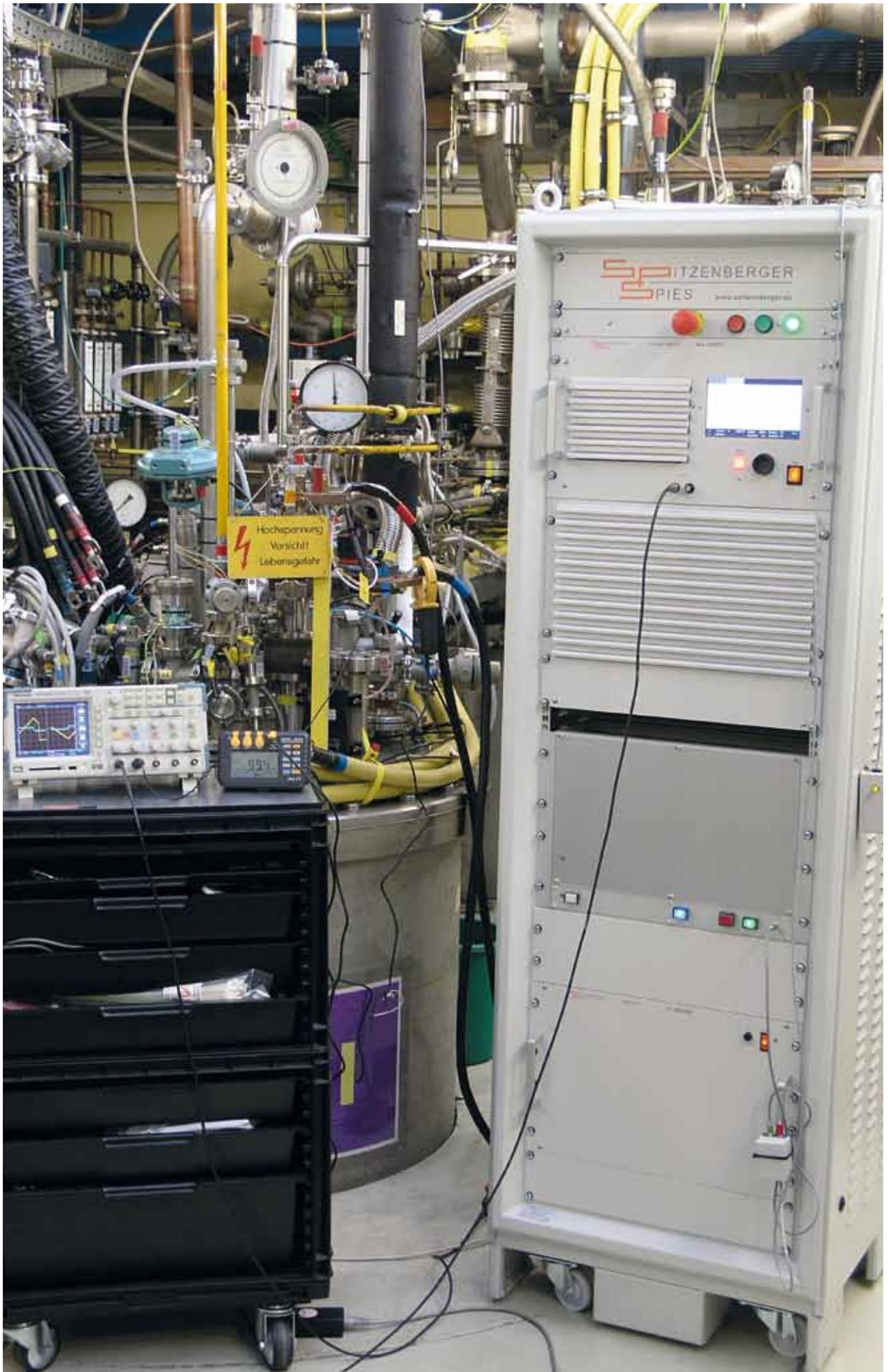
*Abnahmetest des Vier-Quadranten-Netzgeräts an HOMER I: NbTi-Sektion der Anlage als Test-SMES mit ca. 0,3 MJ gespeicherter magnetischer Energie.*
