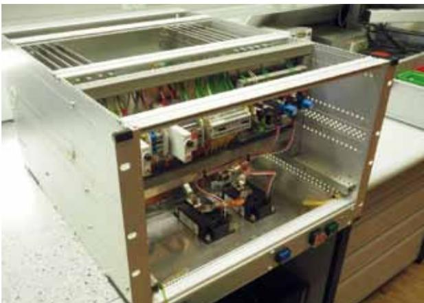
**Abb. 3: Abschalt- und Überspannungsschutz für 4Q-Netzgerät mit Entladewiderstand.**
