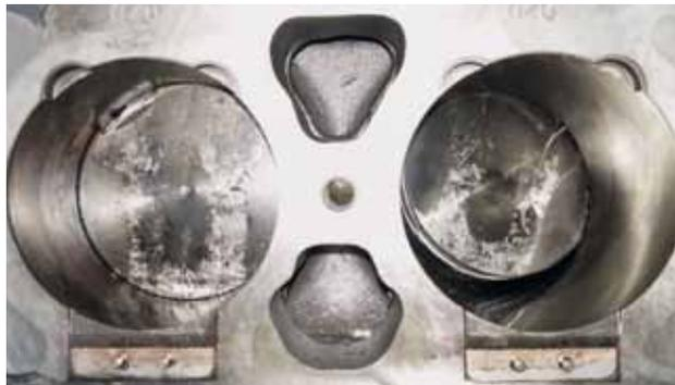
Abb. 2: Einblick in den zerstörten Zylinder des Kaltwassersatzes der 2-kW-He-Tieftemperaturanlage.
