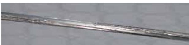
Abb. 2: Beispiel eines HTS CroCo Körpers, gefertigt in einem Schritt inklusive Verdrillung.
