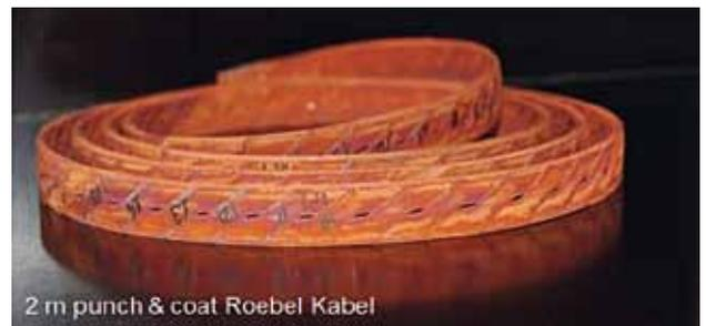
Abb. 10: Innovatives Punch & Coat-Roebel-Kabel für Wickelexperimente mit zehn Strands und zwölf Millimetern Breite.
