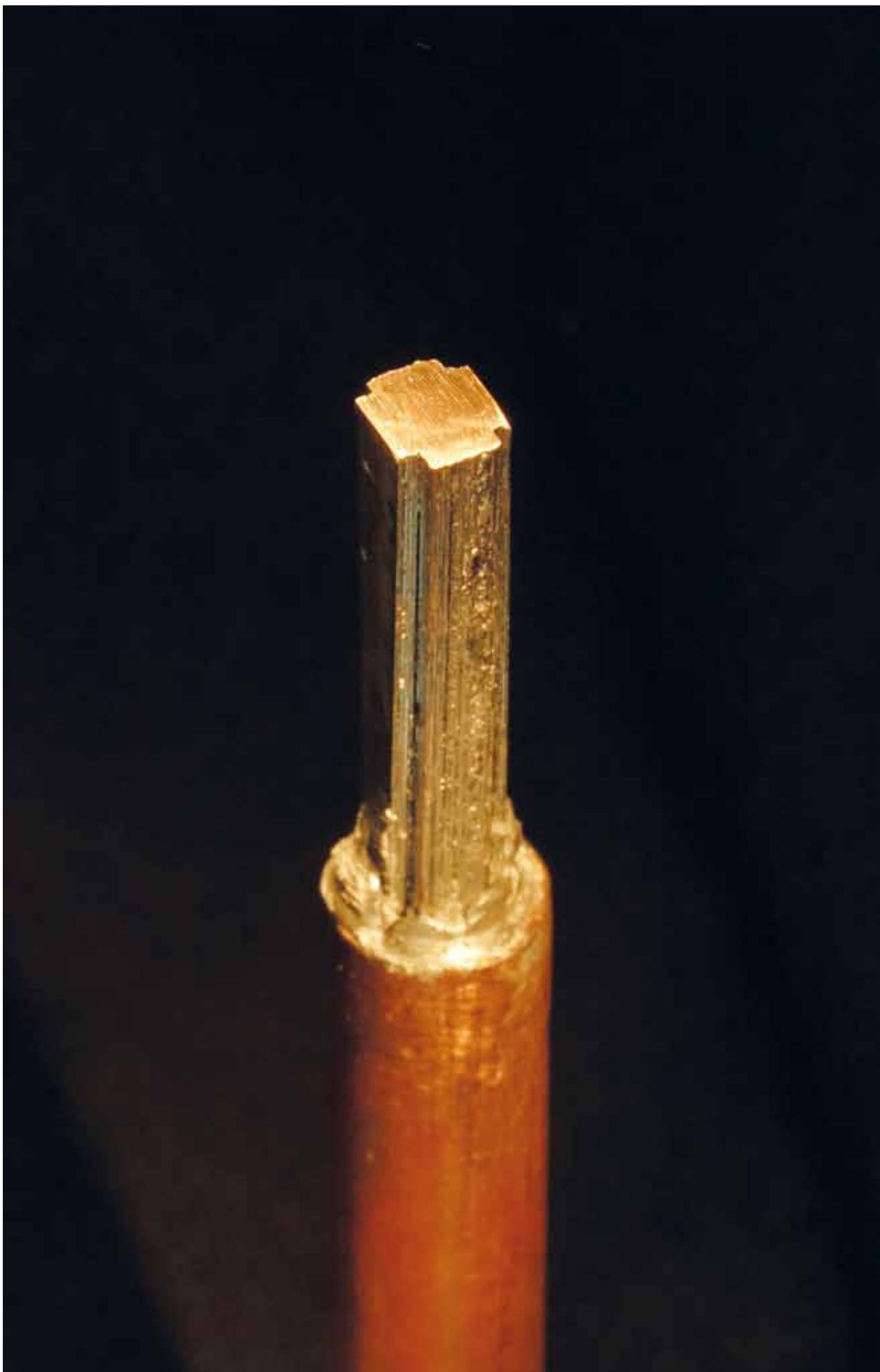
*Neu entwickelter Kreuzleiter (HTS CroCo) für Hochstromanwendungen.*
