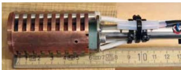
Abb. 10: Supraleitende Füllstandssonde.
