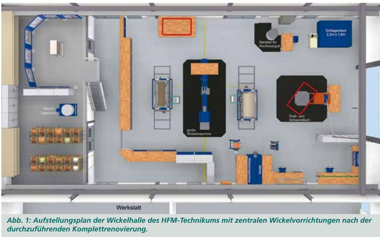
Abb. 1: Aufstellungsplan der Wickelhalle des HFM-Technikums mit zentralen Wickelvorrichtungen nach der durchzuführenden Komplettrenovierung.
