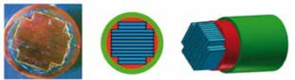
Abb. 3: Querschnitt durch einen gefertigten HTS CroCo sowie Querschnitt und Seitenansicht im Modell.
