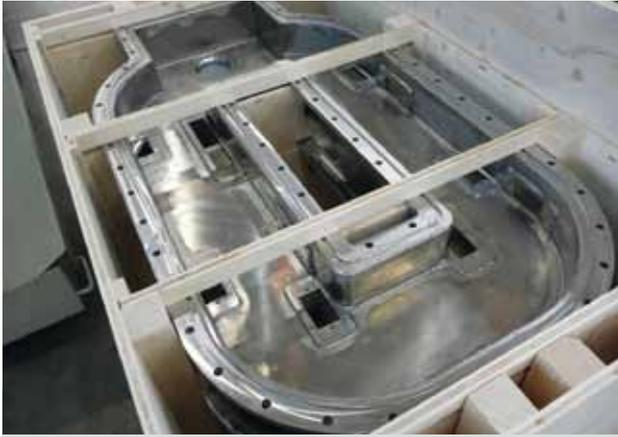
Abb. 7: Eine Hälfte des Vakuumbehälters.
