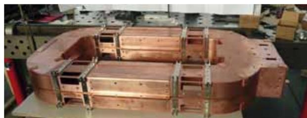
Abb. 6: Thermischer Schild mit Halterungen für das Stützsystem.
