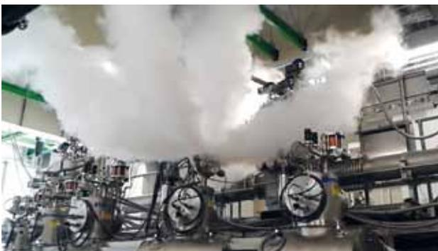
Abb. 3: Quenchttest der DPS-Magnete.
