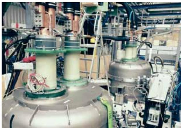
Abb. 11: Doppeltest von zwei Stromzuführungspaaren.
