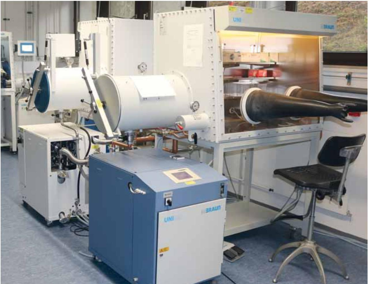
*Mehrzonenofern zur kontinuierlichen Bandleiter-Glühung (oben), „Boxengasse“ zur Materialbearbeitung unter Inertgas (unten).*
