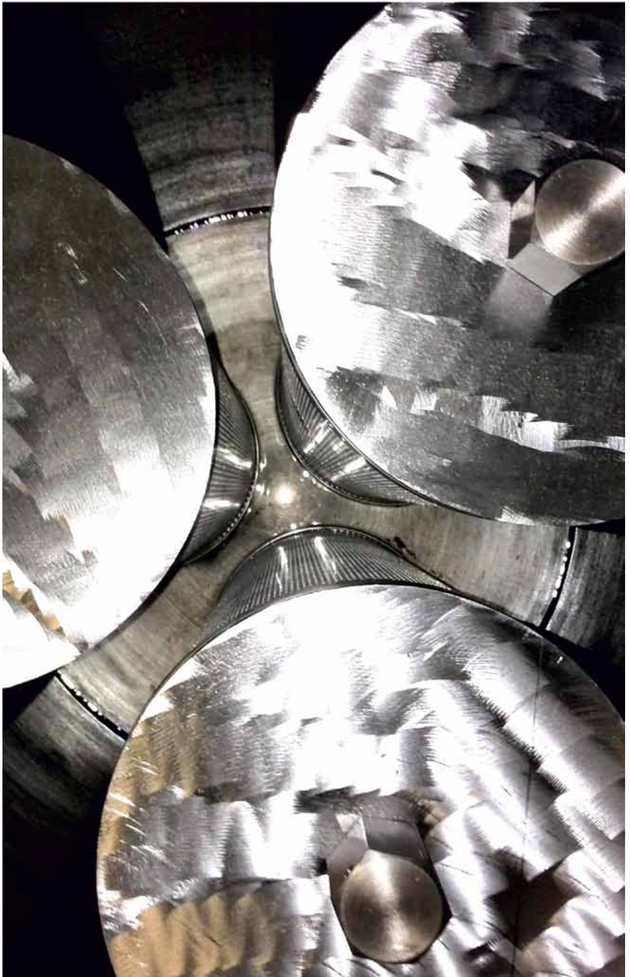
Tiefe Einblicke in den Ölabscheider F1210 der 2 kW-Helium-Tieftemperaturanlage.
