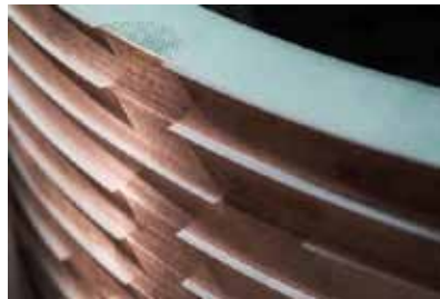
Abb. 10: Funktionsmodell eines induktiv gekoppelten supraleitenden Strombegrenzers.
