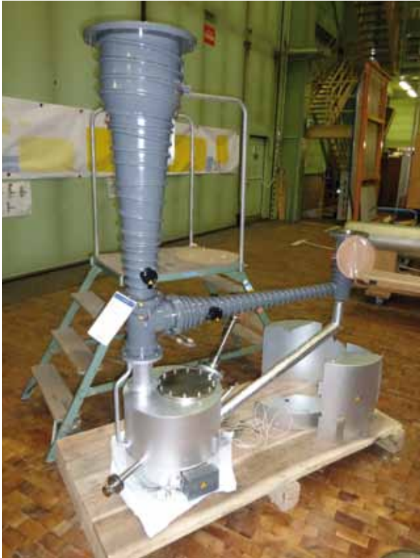
Abb. 2: Blick auf die Boosterstufe des JET-Pumpstandes (vor der Modifikation auf Tritiumverträglichkeit).
