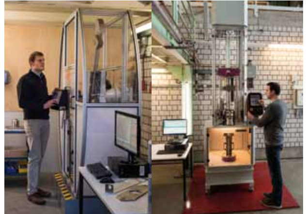
Abb. 13: GADALBINI Kerbschlag Tester (links); INSTRON Fallgewicht-Turm (rechts).
