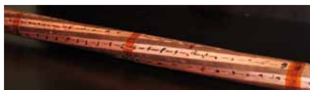
Abb. 19: Rutherford-Kabel, bestückt mit sechs Roebel-Strands.
