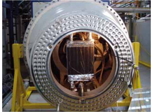
Abb. 3: Blick auf das zu untersuchende Test-Kryopanel (oben) und Einbau des Testeinbaus in die Versuchsanlage TIMO-2 (unten).
