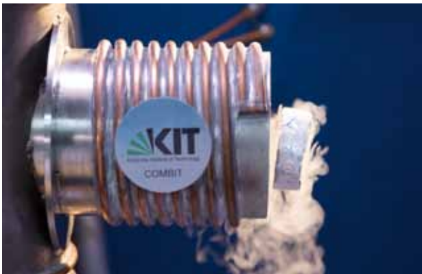
Abb. 15: Supraleitender Magnet des Projekts COMBIT unter Felderregung. Eine auf 77 K abgekühlte supraleitende YBCO-Scheibe levitiert im Magnetfeld.
