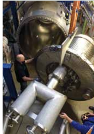
Abb. 3: Blick auf das zu untersuchende Test-Kryopanel (oben) und Einbau des Testeinbaus in die Versuchsanlage TIMO-2 (unten).
