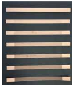
Abb. 1: Lasergebrannte Filamentstrukturen in REBCO-Leitern mit zehn bis 120 Filamenten auf 12 mm Bandbreite.
