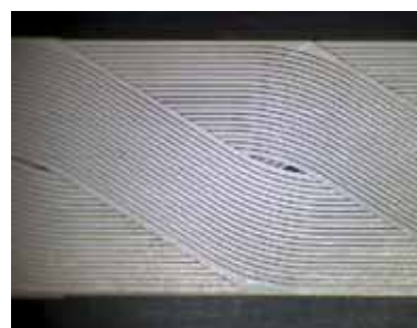
Abb. 3: Strand eines Roebel-Leiters mit Filamentstruktur. Breite des Bands 5,5 mm.
