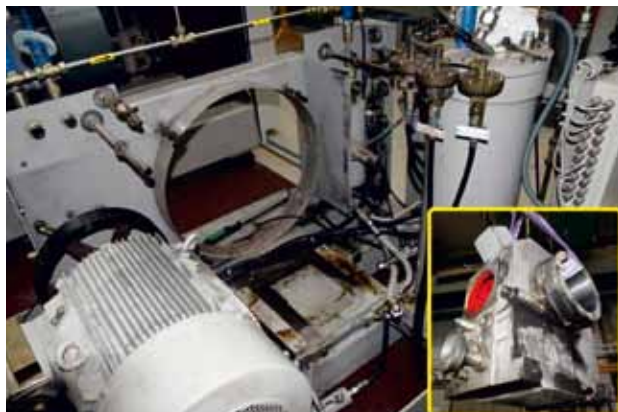
Abb. 3: Reparatur eines Totschadens am Triebwerksgehäuse des V40.
