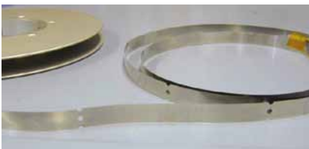
Abb. 5: Stahlbandprobe mit Laserstruktur eines Mikro-Undulators für Stapelanordnung zur Stromerhöhung. Die Löcher dienen zur Justage.
