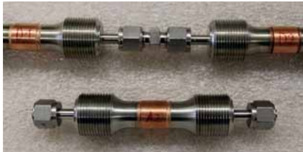
Abb. 2: Kaltlecktests an VA-Cu-Schweißverbindungen von Materialproben.
