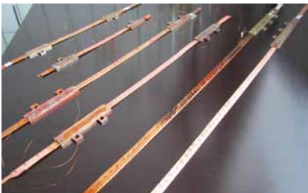
Abb. 12: Sechs Roebel-Leiter mit Transpositions-längen von 126 mm, 226 mm und 426 mm aus Bandleitern von SuperPower und SuperOX.
