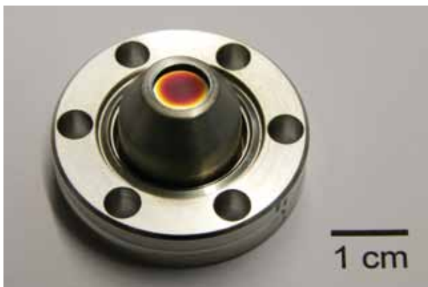
Abb. 9: Optische Fenster der Probenzelle mit tritiumbeständiger Antireflexionsbeschichtung
