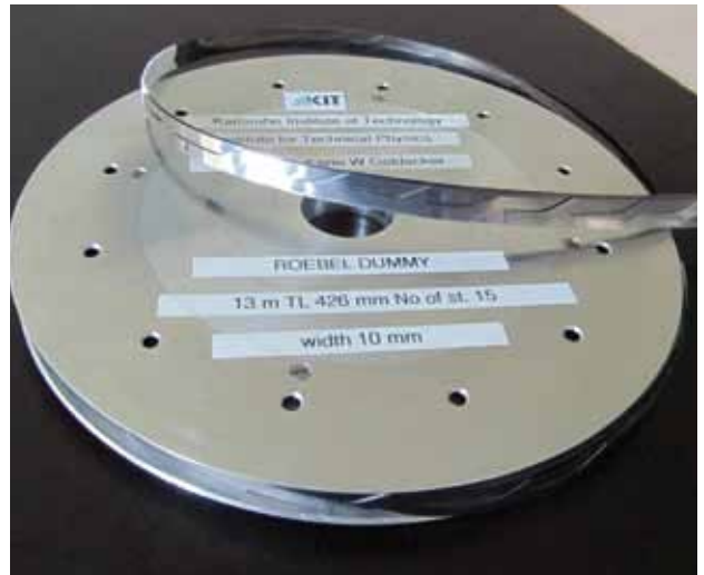
Abb. 6: Edelstahl-Roebel-Leiter als Dummy mit Originalabmessungen für Wickelversuche mit Einsatzspulen der LHC-Dipolmagnete des CERN.
