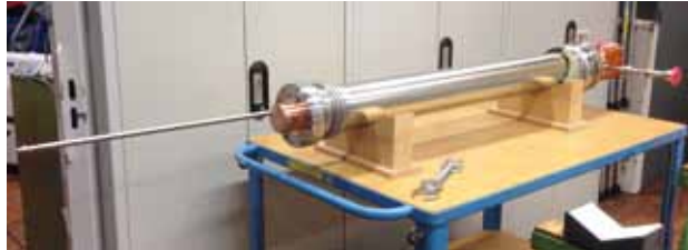
Abb. 2: 20 kA-Wärmetauscher nach erfolgreicher TÜV-Abnahme.
