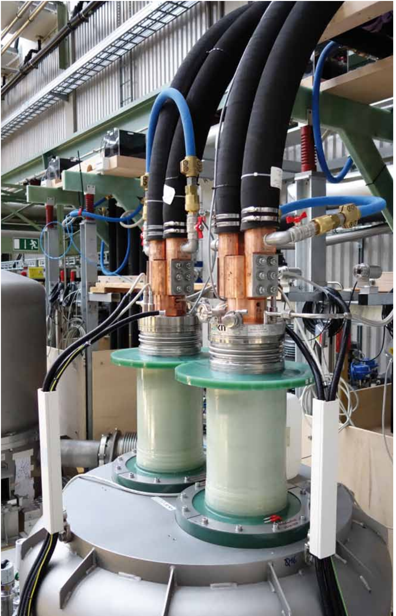
Erster Test zweier Stromzuführungen für JT-60SA in der neuen Testanlage CuLTKa.
