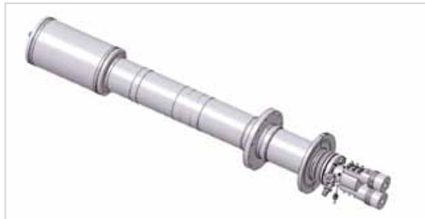
**Abb. 2: CAD-Modell der 26-kA-Stromzuführung für JT-60SA.**
