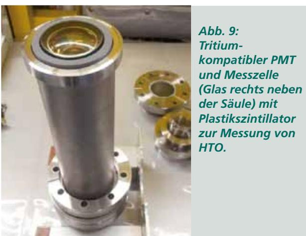
**Abb. 9:** Tritiumkompatibler PMT und Messzelle (Glas rechts neben der Säule) mit Plastiksintillator zur Messung von HTO.
