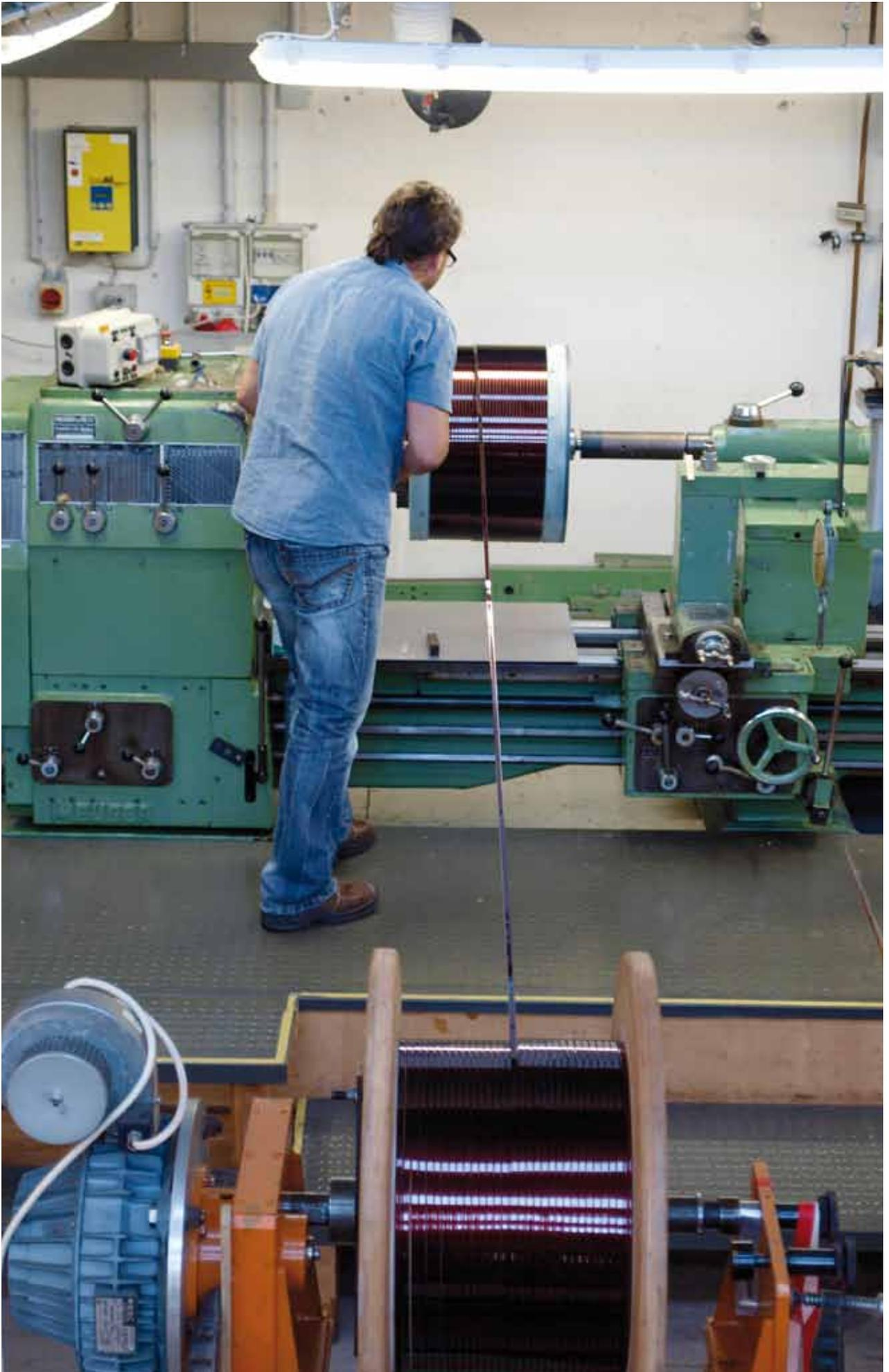
*Technikum des Bereichs Supraleitende Hochfeldmagnete: Fertigung eines Kupfersolenoids für einen supraleitenden Strombegrenzer mit induktiver Widerstandseinkopplung.*
