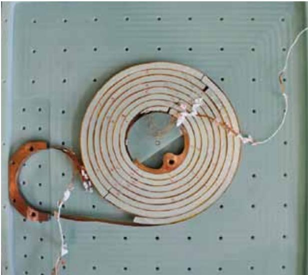
**Abb. 4:** Wicklung eines 5-m-Roebel-Kabels in Pancake-Geometrie mit variablen Distanzstücken im Wickelpaket (Draufsicht).
