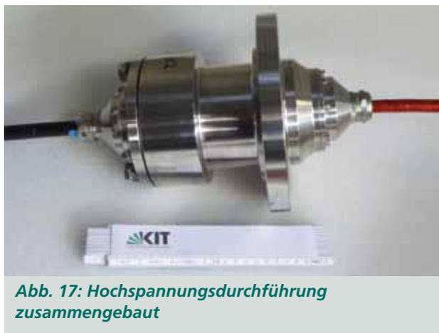
Abb. 17: Hochspannungsdurchführung
