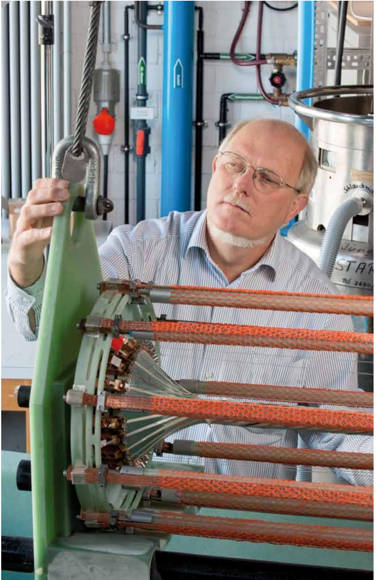
Modell eines Energiekabels für das Projekt AMPACITY; Teilbestückung mit Supraleiterbändern (innere Phase).
