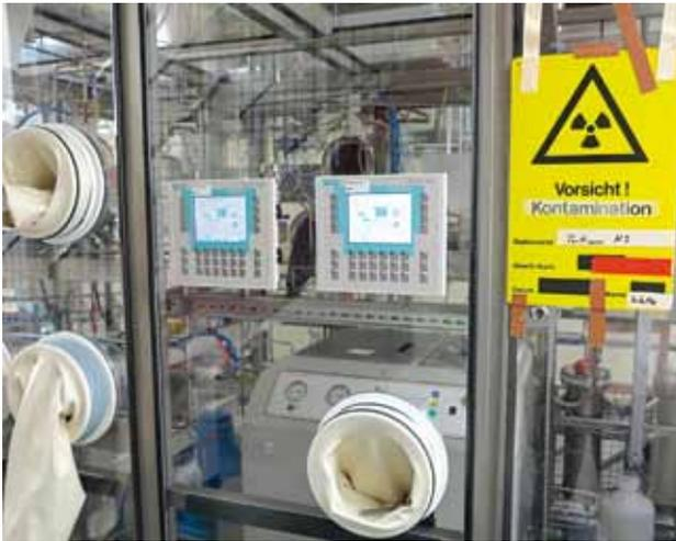
**Abb. 2:** Blick in den TRENTEA-Caisson (begehbarer Abzug) mit den Elektrolyseuren und neuen Bedienpanels.
