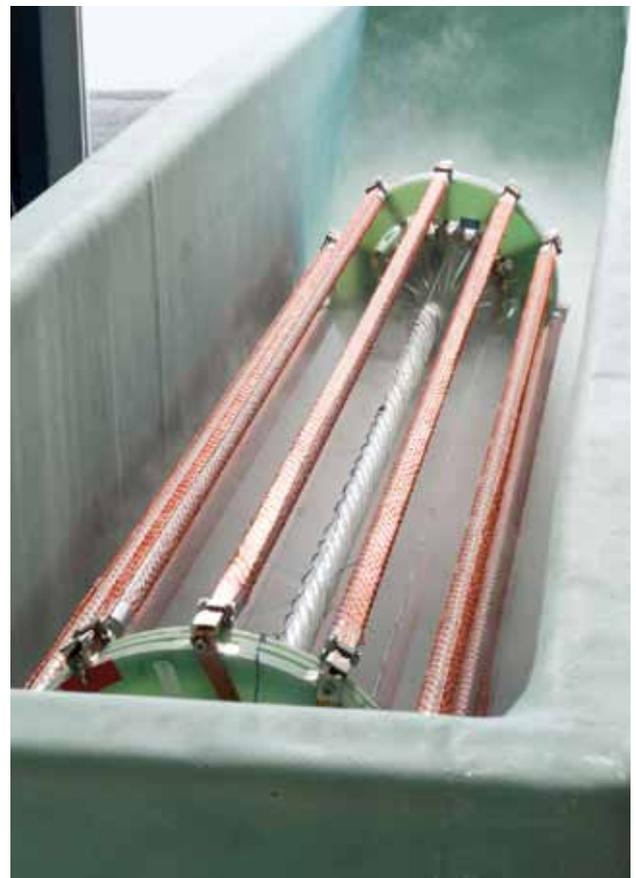
**Abb. 6:** Modell des Energiekabels im flüssigen Stickstoff.
