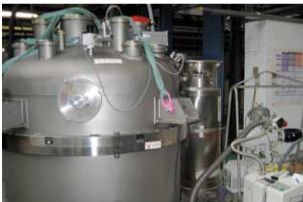
Abb. 4: Zyklieren des Kühlschildes mit LN<sub>2</sub> + Lecktest.
