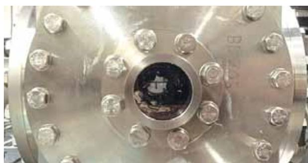
**Abb. 11:** Messzelle für IR-Messungen an flüssigem Wasserstoff. Im Zentrum des Flansches ist der Flüssigkeitsspiegel des etwa 23 K kalten Wasserstoffs zu sehen.
