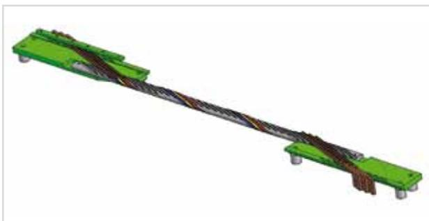
**Abb. 5:** Rutherford-Modellkabel im CAD-Entwurf (oben) und bestückt mit drei Roebel-Strands zur Strommessung.
