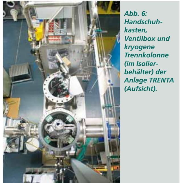
**Abb. 6: Handschuhkasten, Ventilbox und kryogene Trennkolonne (im Isolierbehälter) der Anlage TRENTA (Aufsicht).**
