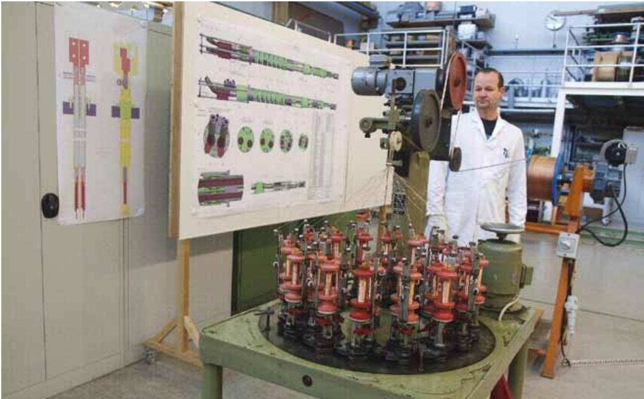
Abb. 4: Flechtmaschine im Technikum zur Herstellung der Kupfergeflechte für Stromzuführungen.
