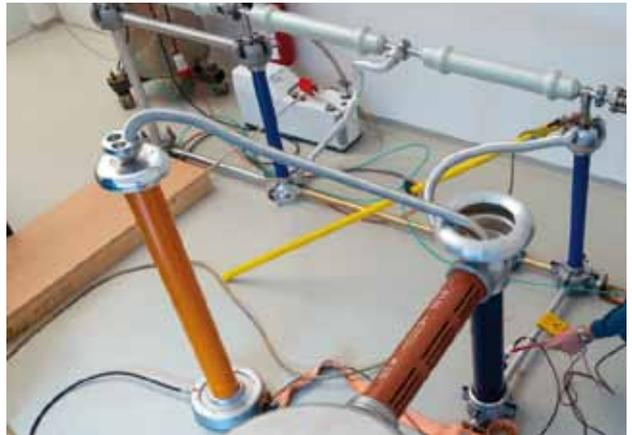
Abb. 5: Raumtemperatur-Hochspannungstrenner im Test.
