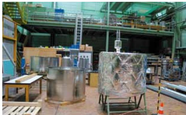
Abb. 3: LN<sub>2</sub>-Kühlschild mit MLI.
