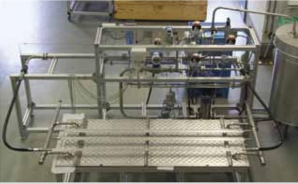
**Abb. 11: Anlage THEA zur experimentellen Bestimmung der Druckverluste an den Schildkomponenten.**
