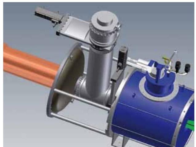
Abb. 4: Skizze der Schnittstelle zwischen DPS und WGTS. An dieser Stelle soll eine zusätzliche Pumpkammer eingebaut werden, um mindestens den notwendigen Tritiumflussreduktionsfaktor von  $10^5$  zu erreichen.
