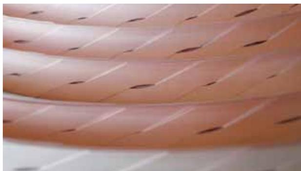
**Abb. 3:** Roebel-Leiter aus REBCO-Bandleiter mit 5 m Länge, 10 Strands und 12 mm Breite.
