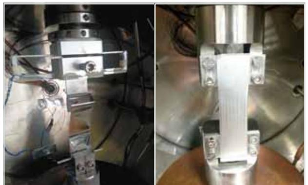
Abb. 6: Abschältest (180°) und Zugtest (0°) eines speziellen Al-Klebebandes bei 4.2 K.
