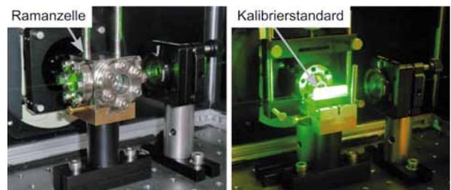
Abb. 8: Der Fluoreszenzstandard kann an die Stelle der Ramanzelle gesetzt werden, um die spektrale Effizienz des Ramansystems zu bestimmen.
