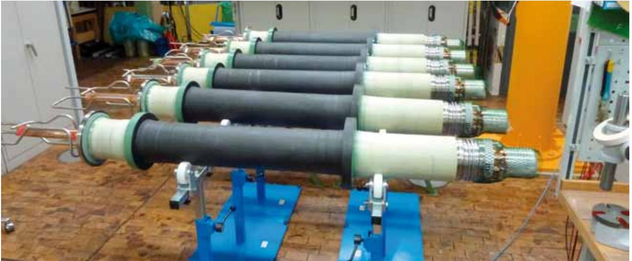
Abb. 11: Serienfertigung der Stromzuführungen für W7-X
