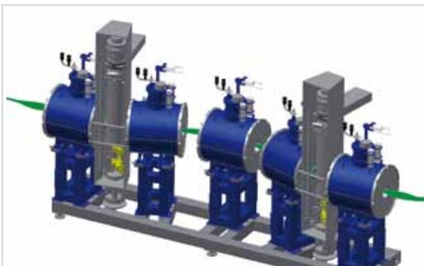
Abb. 3: Neues Konzept für die differenzielle Pumpstrecke von KATRIN. Zu sehen sind die fünf supraleitenden Magnete und zwei der fünf geplanten Pumpkammern.
