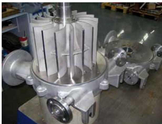
Abb. 6: Blick auf den Ringpumpenrotor.
