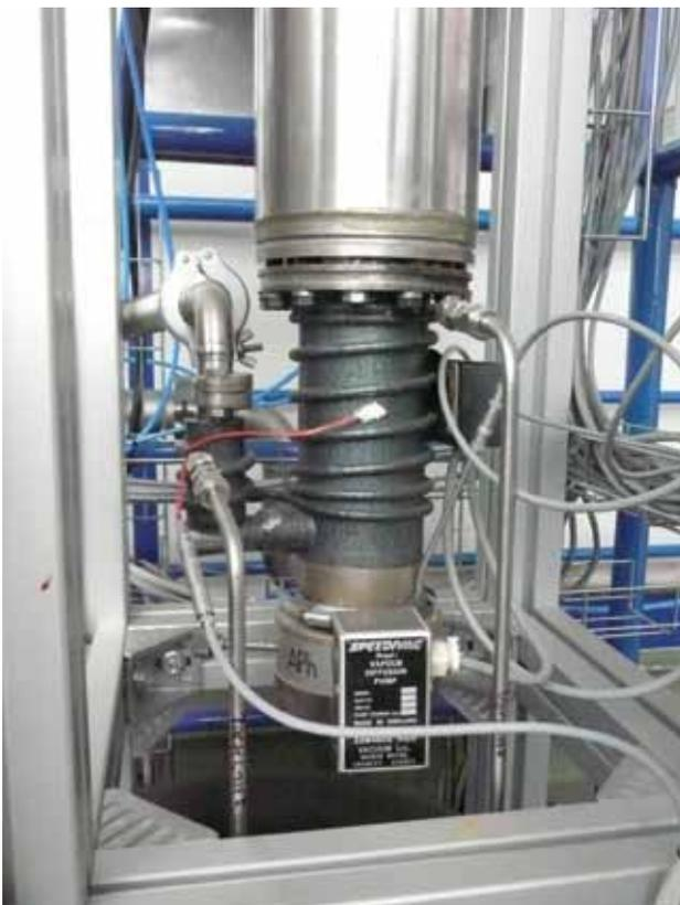
Abb. 4: Getestete Quecksilberdiffusionspumpe.
