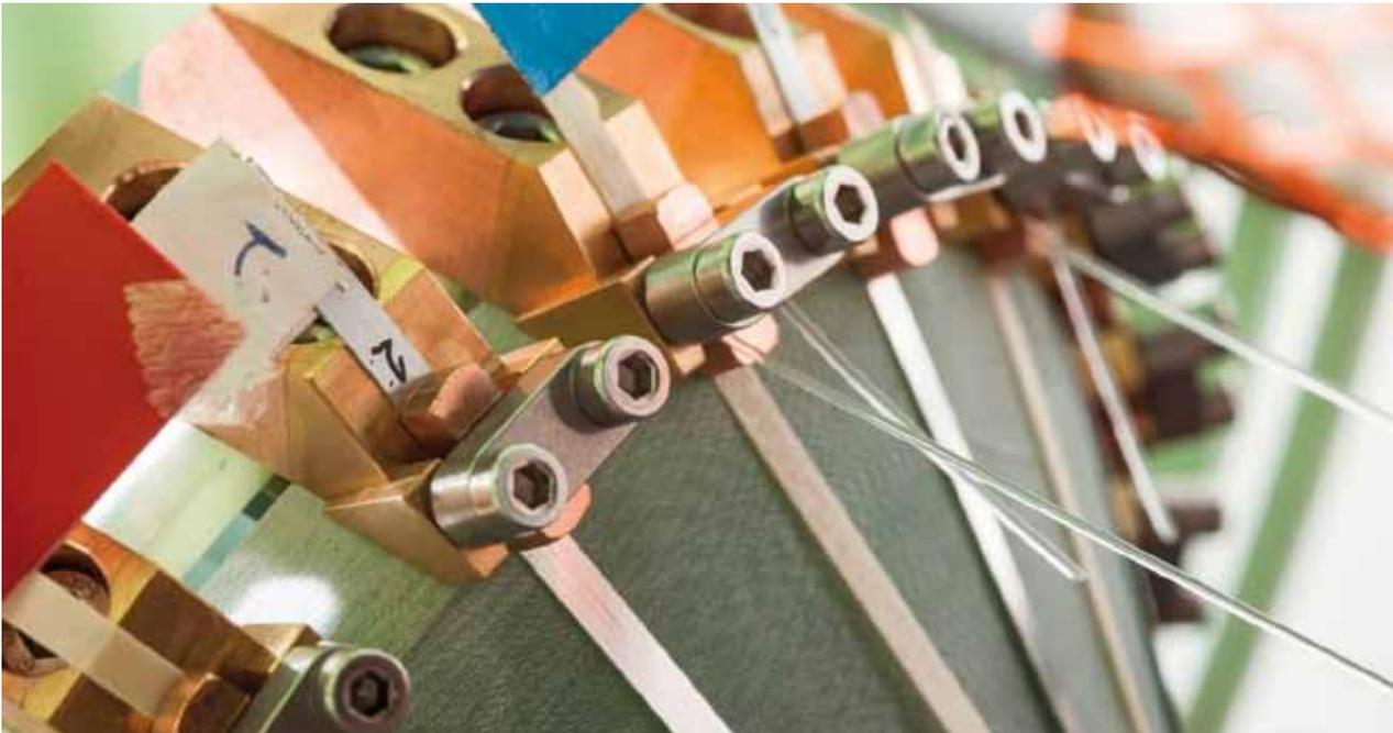
**Abb. 7:** Teilansicht des Energiekabels im Kontaktbereich. Bestückt ist die innere Phase.
