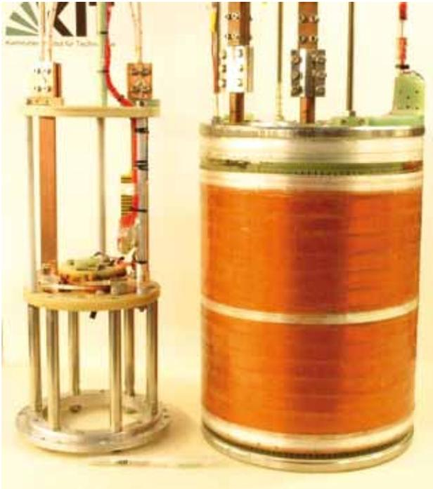
**Abb. 2: Versuchsanordnung zur Charakterisierung eines REBCO-Doppelpancakes im Rahmen des EuCARD-Projekts.**
