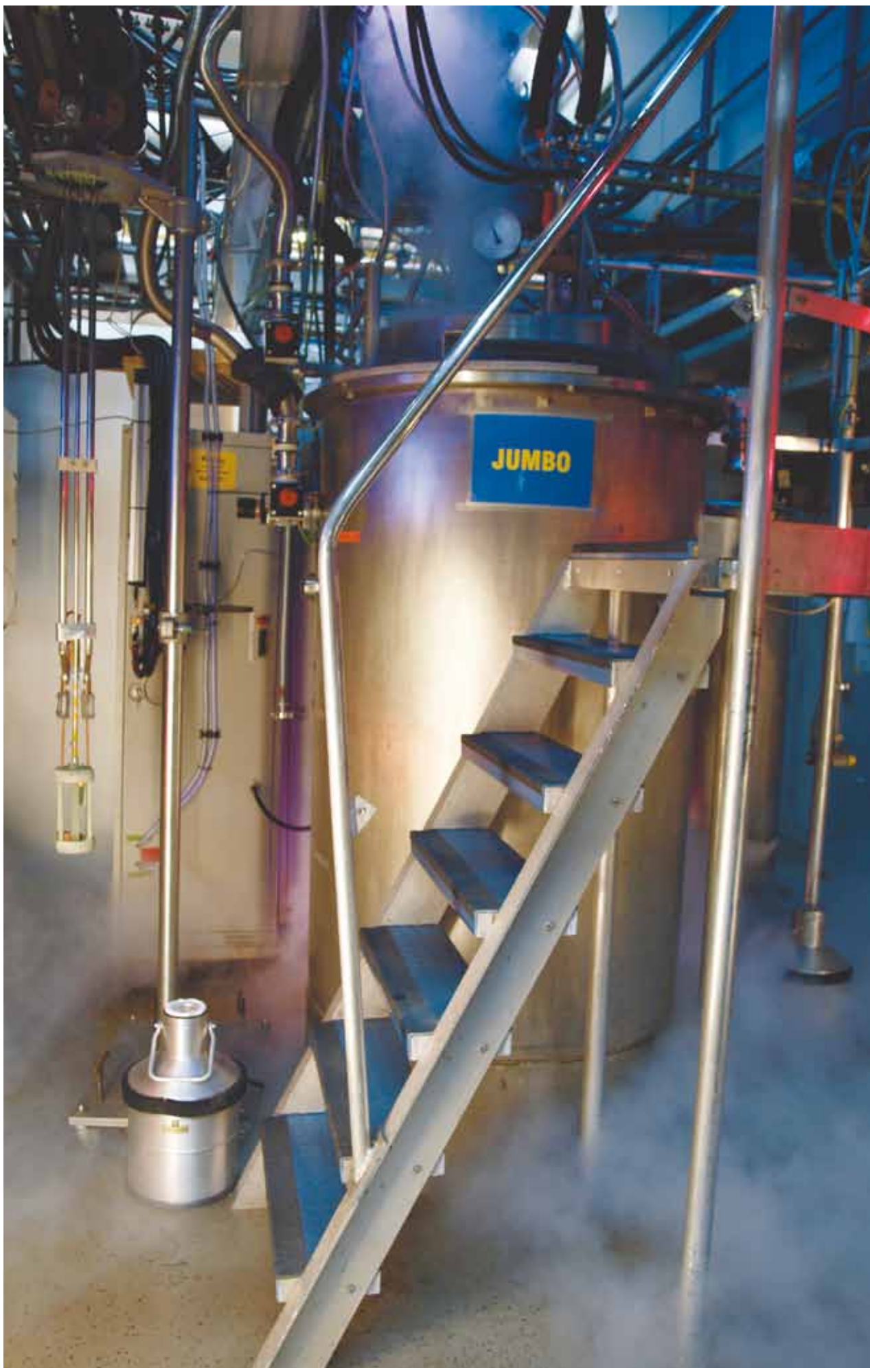
33 Jahre im Routinebetrieb: Supraleitende Experimentieranlage JUMBO mit Magnetfeldern von 10 T in einer 100 mm freien Bohrung bzw. 15 T in einer 44 mm freien Bohrung.
