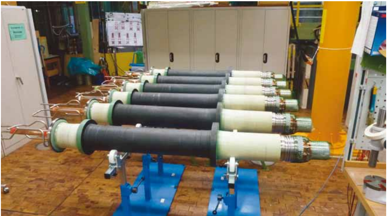
Abb. 7: Serienfertigung der Stromzuführungen für W7-X.
