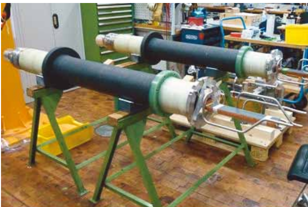
Abb. 1: W7-X Serien-Stromzuführungen nach dem Zusammenbau.
