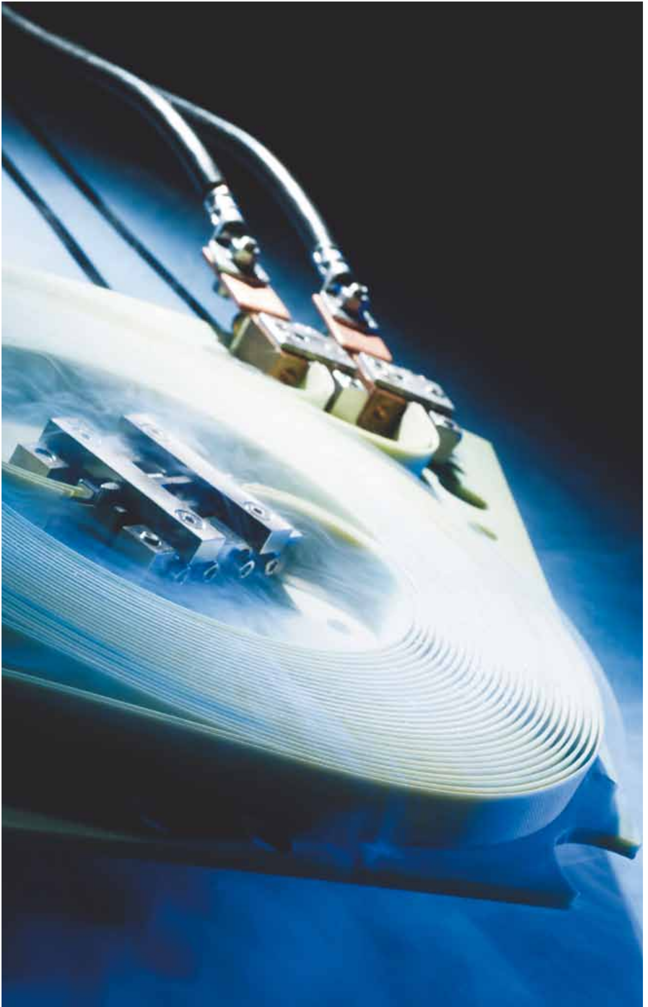
Strombegrenzerkomponente aus der zweiten Generation von Hochtemperatur-Supraleitern.
