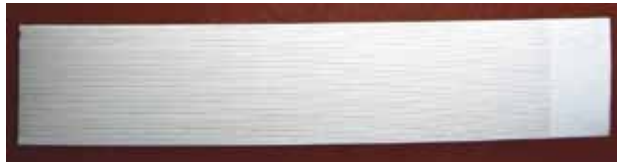
Abb. 2: Bandleiter mit 40 eingetragenen Filamenten.
