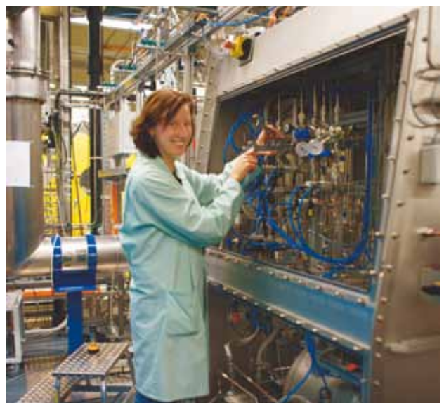
Abb. 2: Blick auf einen Teil der TRENTA Anlage. Die Handschuhbox bildet die Verbindung zwischen WDS und ISS.
