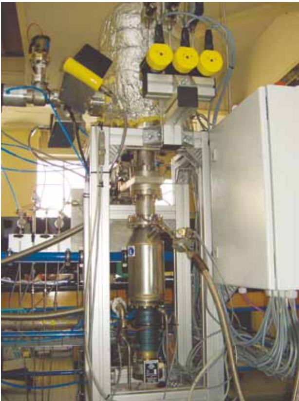
Abb. 5: Das THESEUS Aufbauteam bei der Einweihung (oben). Blick auf die Quecksilberdiffusionspumpe im Betrieb (unten).
