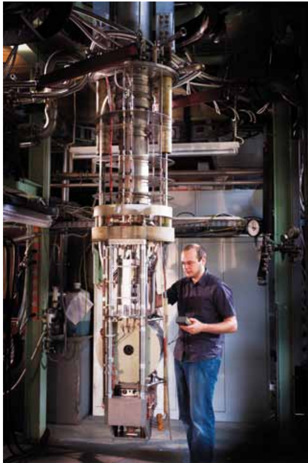
Abb. 6: FBI Anlage zur Messung kritischer Ströme unter mechanischer Belastung im Magnetfeld.
