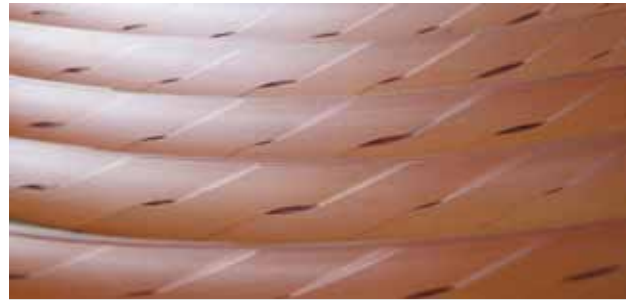
Abb. 14: Verseilte HTS-Roebel-Leiter mit zehn Strands, 2 m Länge und 12 mm Breite für Untersuchungen bei CERN.
