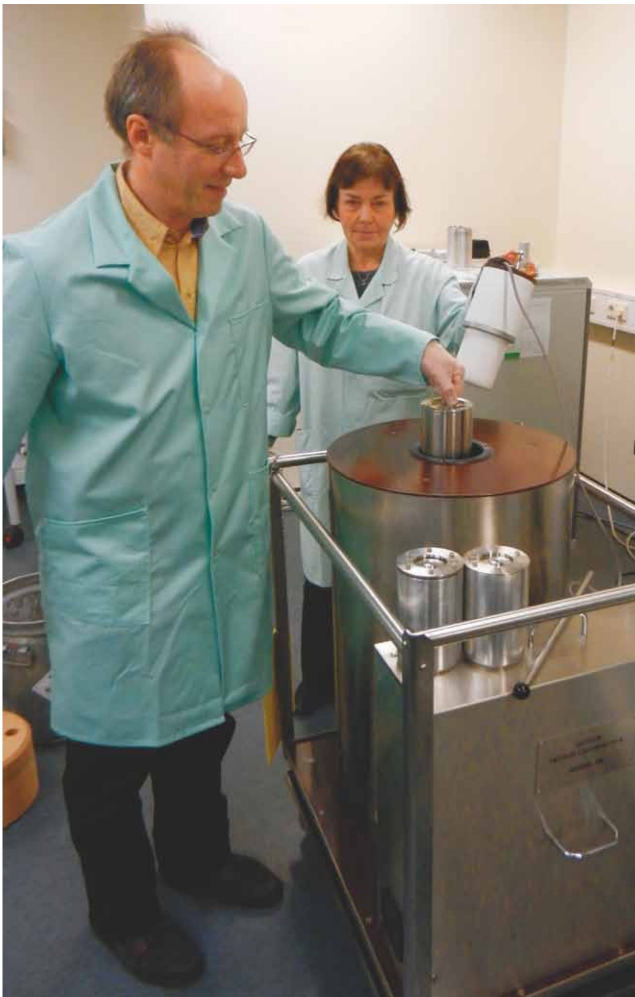
Anlieferung von 2*2,5 Gramm Tritium im November 2011. Zur Eingangskontrolle und späteren Bilanzierung wird die Aktivität mit einem TLK Kalorimeter nachgemessen. Zu sehen ist das Einsetzen des zweiten Behälters in das Kalorimeter.
