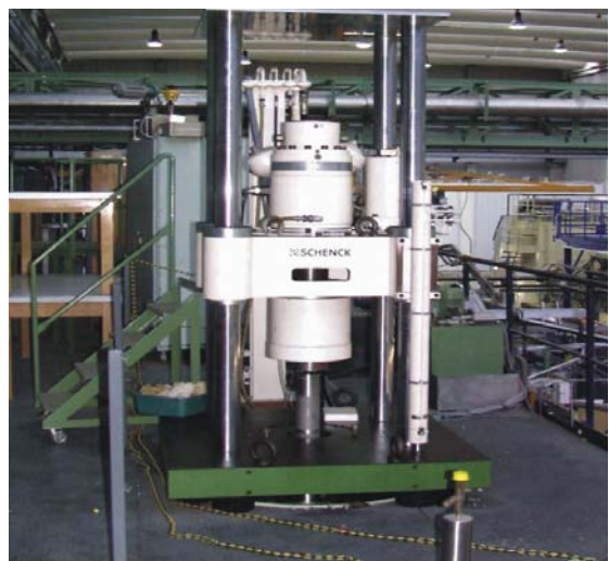
Abb. 26: Messplätze zur Charakterisierung von Tieftemperatur-Strukturmaterialien a) für Miniaturproben (2,5 t) b) für Standardproben (60 t)
