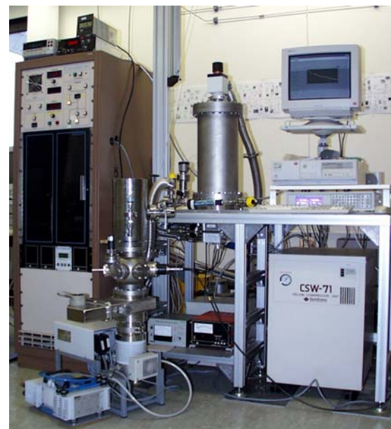
Abb. 2: Beschichtete Kryopanelle für ASTRIUM (oben). Das Sorptionsverhalten der kreisrunden Probe (2. v. rechts) wurde in der Anlage COOLSORP nachgewiesen (unten).
