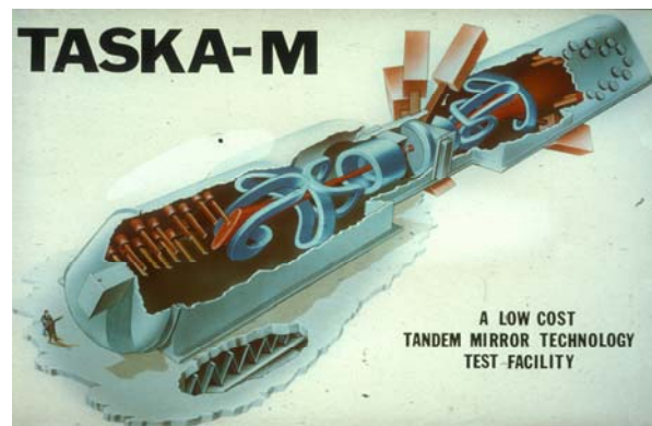
Abb. 5: Die TASKA-M Studie für eine 14 MeV Neutronenquelle auf der Basis einer Tandem-Spiegelmaschine
