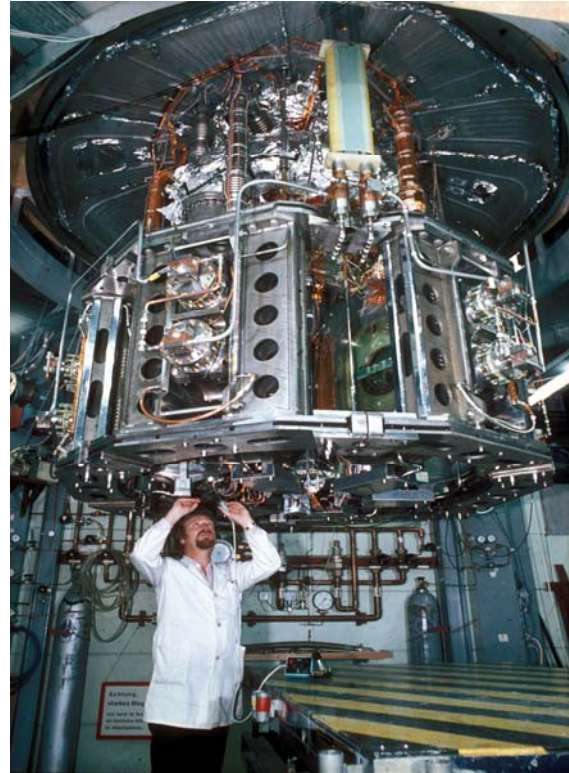
Abb. 4: Der TESPE-Torus als Vorexperiment zum LCT und für spätere Magnetsicherheits-Experimente sowie W7-X Leiteruntersuchungen
