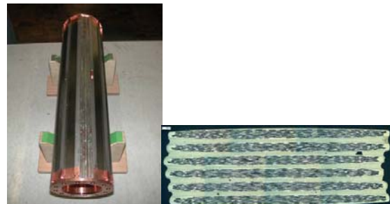
Abb. 4: 1:1 Modell des HTSL-Bauteils (links) und Querschnitt eines HTSL-Bandleiterstapels
