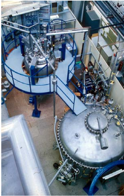
Abb. 8/9: Die HELITEX-Anlage zur Entwicklung von LHe-Pumpen und zur Untersuchung von He-Zwangsströmungskreisen
