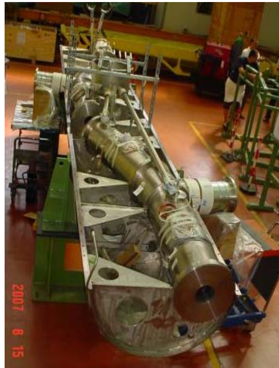
Abb. 3: DPS2-F: Montage der 5 Magnetbaugruppen
