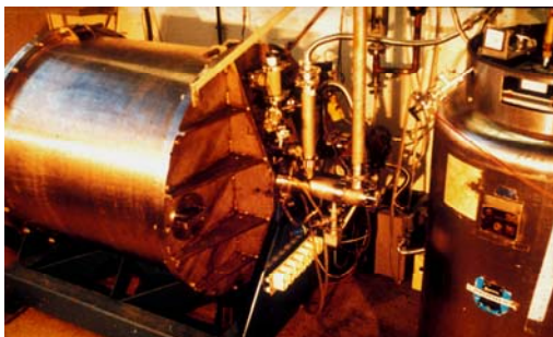
Abb. 10: Anlage ROTAX zur Untersuchung der Kühltechnik supraleitender Turbogeneratoren
