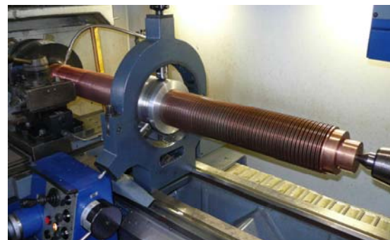
Abb. 3: 1:1-Modell des Wärmetauschers
