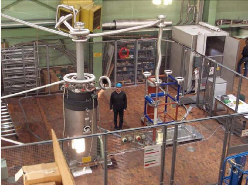
Abb. 8: Teststand FATELINI (Facility for Testing Liquid Nitrogen) zur Untersuchung der dielektrischen Festigkeit von flüssigem Stickstoff bei hohen Spannungen
