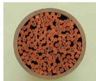
Abb.1: Querschnittsansicht des kleinsten sub-Kabels 3x3 ( $\varnothing$  3.3 mm), des nächst größeren sub-Kabels 3x3x5 ( $\varnothing$  7.6 mm) und der größten "Cable in Conduit" Probe im 3x3x5x4 Layout ( $\varnothing$  15 mm)
