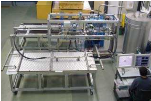
Abb. 3: Messung von Druckverlusten komplexer Bauteile in einem weiten Bereich der Reynolds-Zahl in der Anlage THEA.
