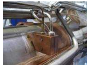
Abb. 5: Temperatursensoren am Strahlrohr (Dampfdruckthermometer/Pt500)
