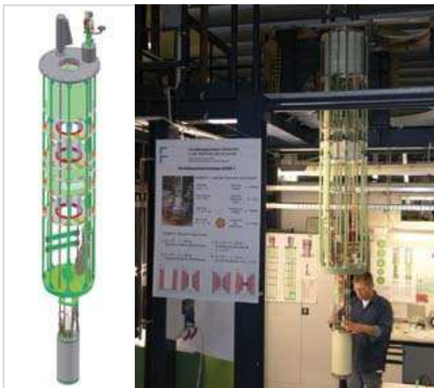
Abb. 3: Magnetflansch zur Aufnahme einer 24 T (\text{NbX})_3\text{Sn} -Einsatzspule.
