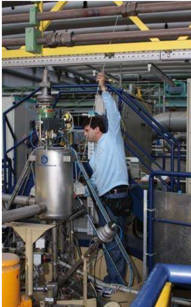
Abb. 8: Implementierung eines neuen Temperatursensors in den 5.000-Liter-Tank der 300 W-Anlage.
