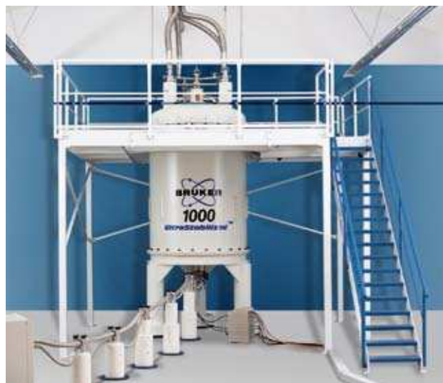
Abb. 6: Weltweit erstes 1000 MHz NMR-Spektrometer mit einer Feldstärke von 23.5 T (siehe www.bruker.biospin.com/pr090601.html )
