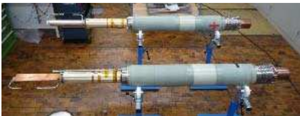
Abb. 2: Prototyp-Stromzuführungen nach der Weichlötung von Wärmeübertrager, HTS-Modul und kaltem Kontakt.
