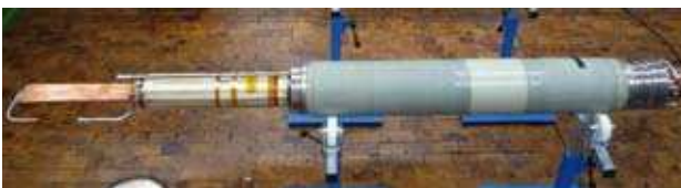
Abb. 1: Prototyp-Stromzuführung beim Zusammenbau der Komponenten Busleiter-Stromanschluss (links), HTS-Modul (Mitte) und Wärmetauscher (rechts, mit isoliertem Vakuumraum).
