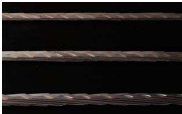
Abb. 3: Roebel-Kabel mit 15, 35 und 50 Leitern (von oben nach unten) und 4 mm Breite.
