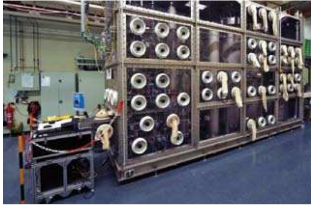
Abb. 7: Blick auf die ISS Handschuhbox mit dem angeschlossenen LARA System. Der neu aufgebaute Teil des Tritium Loops befindet sich im linken Teil der Box.
