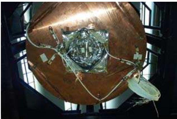
Abb. 5: THISTA; unteres Kühlschild mit Anschluss für Testobjekte und Sensoren.
