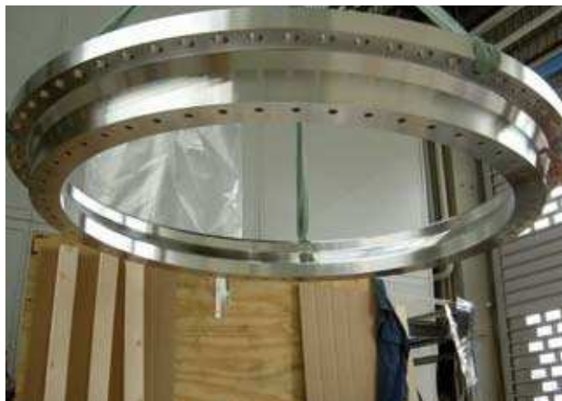
Abb. 2: Der Adapterflansch (2 m Durchmesser), erste Komponente für die neuen Tests in TIMO-2.
