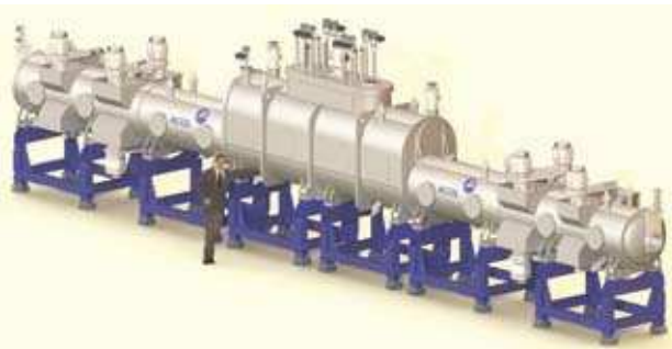
Abb. 3: WGTS Magnetkryostat. Die technologischen Anforderungen an den 16 \text{ m} langen Kryostat sind hoch, sein technischer Aufbau ist äußerst komplex. Das System hat zwölf kryogene Kreisläufe; es werden sechs verschiedene Fluide ( \text{He} , \text{Ne} , \text{N}_2 , \text{Ar} , \text{T}_2 und \text{Kr} ) eingesetzt.
