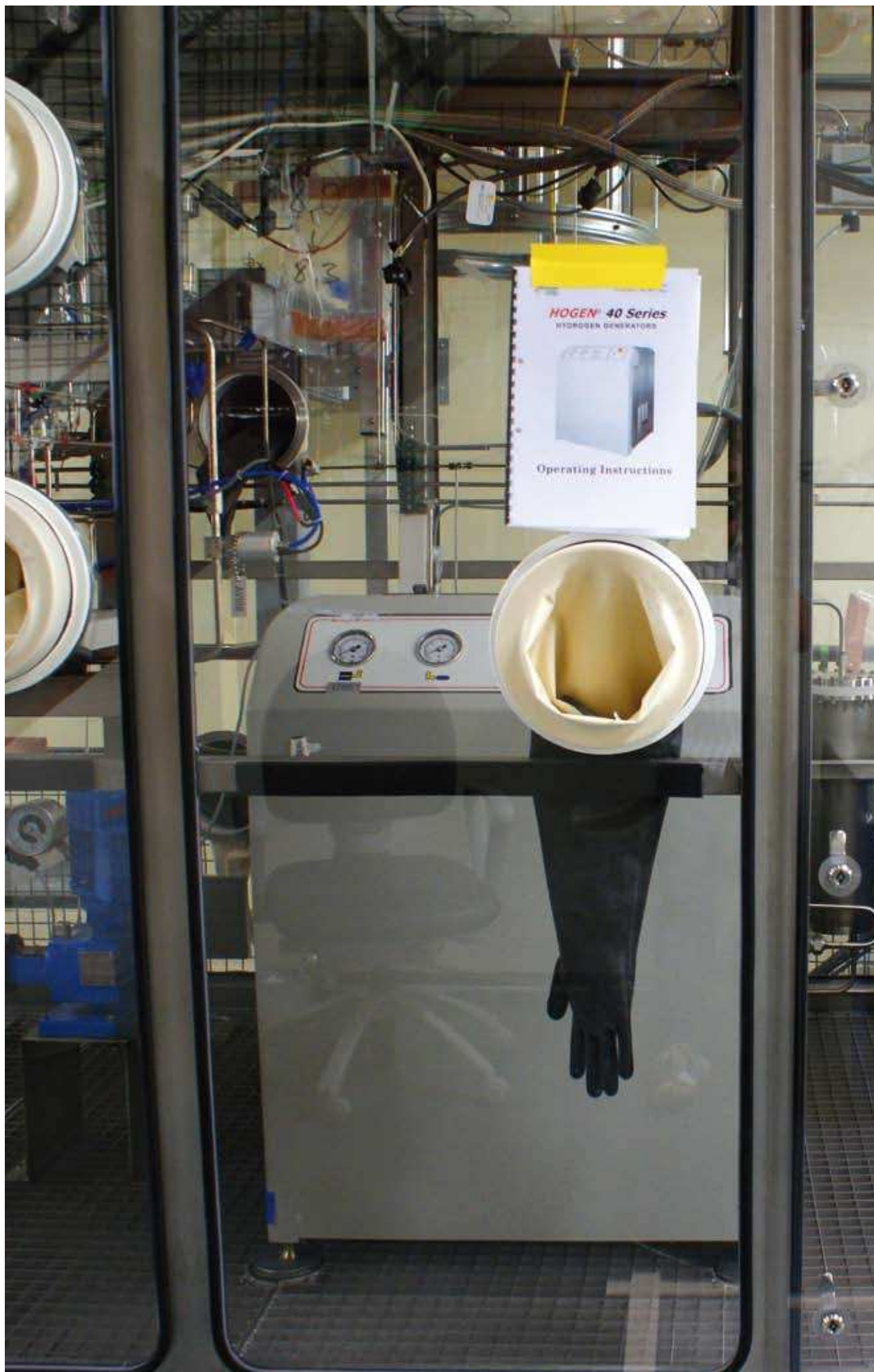
Abb. 3: Elektrolyse-Einheiten im Caisson
