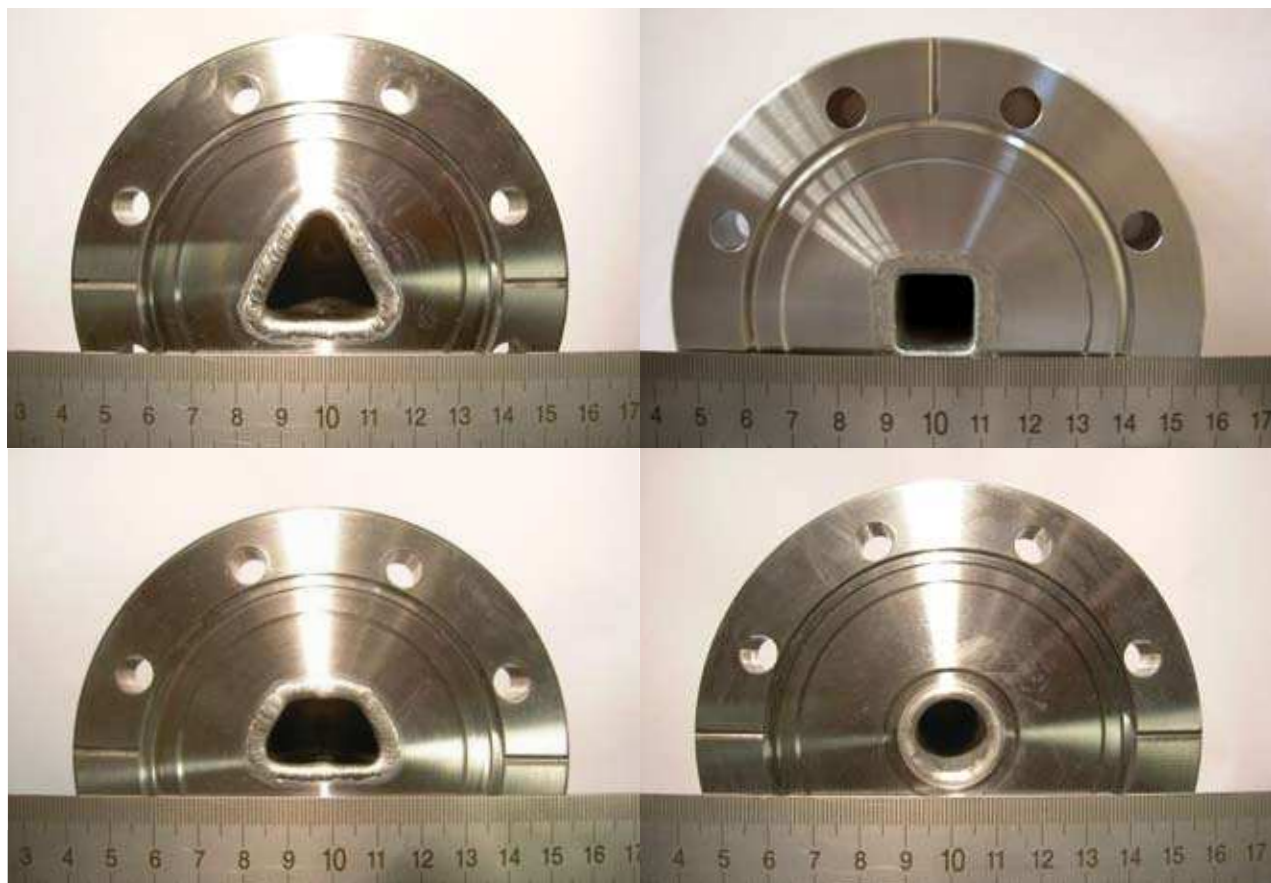
Abb. 3: Gemessene Kanalprofile in TRANSFLOW.
