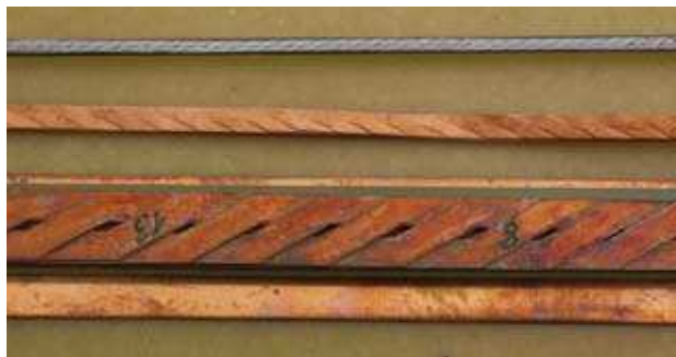
Reduktion der Roebelkabelbreite von 12 mm (unten) auf 4 mm (Mitte) und Stahlbandversuche für 2 mm breite Strukturen (oben)
