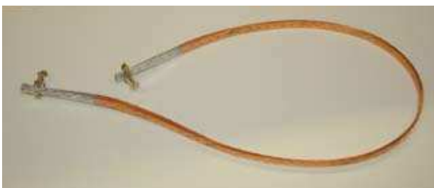
Roebelkabel mit 1.1 m Länge und Transportstrom von 2.6 kA bei 77 K
