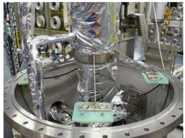
Abb. 4: Kopf der Kryokolonne in der Coldbox
