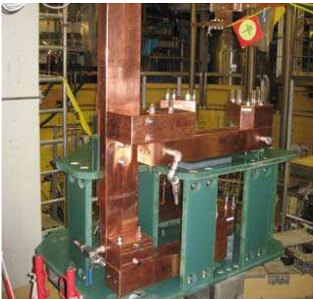
Hochstrom-Verbinder um drei Spulen individuell mit Strom bis 18,2 kA zu beaufschlagen.
