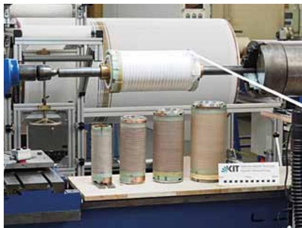
**Abb. 1: Fertiggestellte Einzelsektionen der 5 T-REBCO-HTS-Einsatzspule für HOMER II.**
