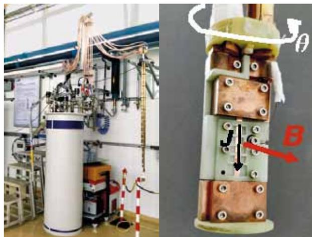
**Abb. 1: 6 T-Split-Coil-System zur Bestimmung der  $I_c$ -Anisotropie von Bandleitern bis 1000 A. Links Kryostat und Probenstab, rechts Probenhalter mit installiertem Bandleiter.**
