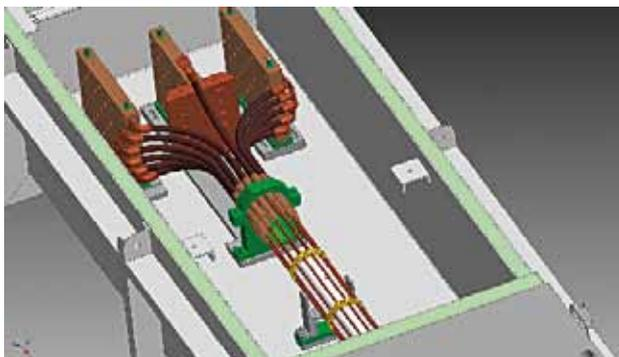
Abb. 7: CAD-Modell des SupraDCKabels.
