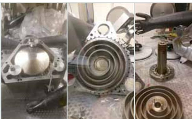
Abb. 1: Demontageschritte an einer tritiumkompatiblen Scroll-Pumpe. In der RBX wird eine bereits mit Tritium betriebene, kontaminierte Pumpe untersucht. Dabei werden Wartungs- und Reparaturstrategien entwickelt sowie Erfahrungen für neu zu fertigende Pumpen gewonnen.
