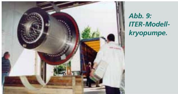
**Abb. 9: ITER-Modellkryopumpe.**
