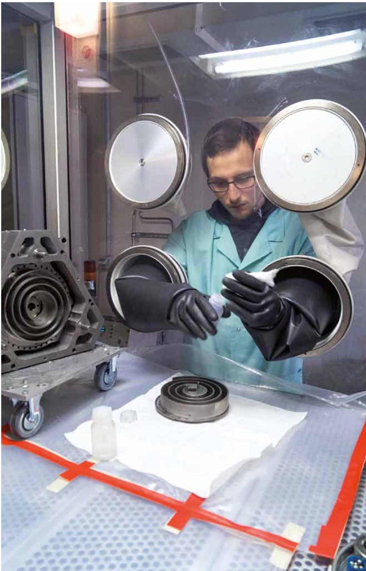
*Blick in die Reparatur-Handschuhbox (RBX) des Tritiumlabors Karlsruhe: Ein Mitarbeiter bereitet eine instand gesetzte Normetex 9 cfm-Scroll-Pumpe für einen Probelauf vor.*
