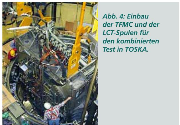
**Abb. 4:** Einbau der TFMC und der LCT-Spulen für den kombinierten Test in TOSKA.
