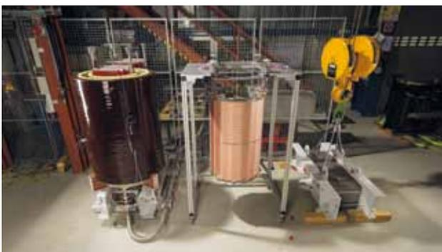
**Abb. 1:** Die wesentlichen Einzelteile des Transformators vor dem Zusammenbau.
