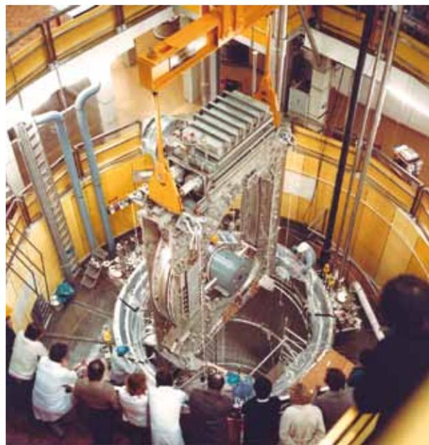
**Abb.2: EURATOM-LCT-Magnet in TOSKA-Testanlage**
