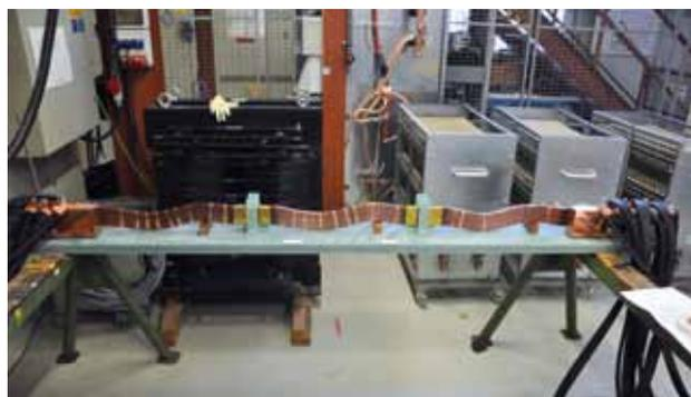
Abb. 18: Subsize-Stromschiene aus drei Segmenten mit zwei Verbindungskontakten und zwei Strom-einkopplungen.
