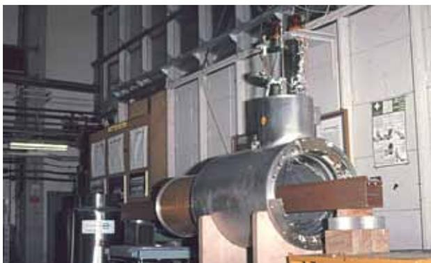
**Abb. 1: Supraleitender Magnet für CELLO Detektor (1979)**
