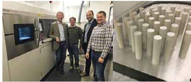
**Abb. 5:** Beteiligte Partner (Politecnico di Torino, TUKE, KIT) mit Additivem Drucker EOSINT M270 (links). Gefertigte 316 L Zylinder (50 mm hoch) zur Probenherstellung für kryogene Tests (rechts).
