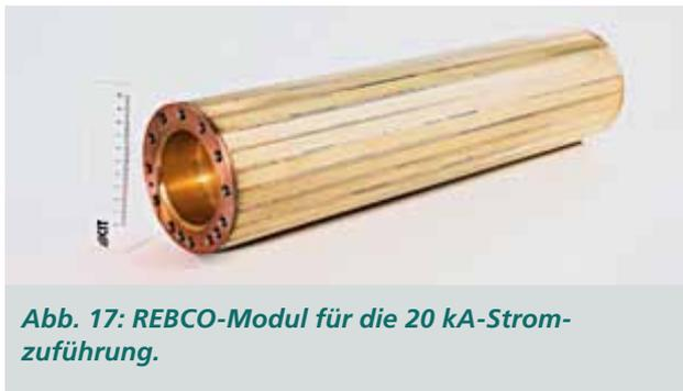
Abb. 17: REBCO-Modul für die 20 kA-Stromzuführung.
