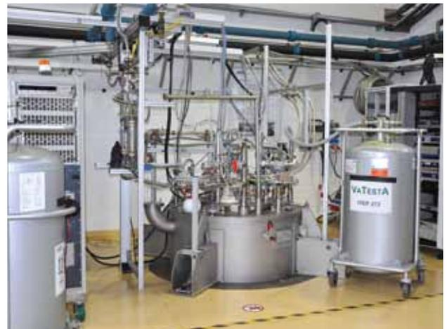
Abb. 7: Die Anlage VATESTA mit dem Einsatzkryostaten.
