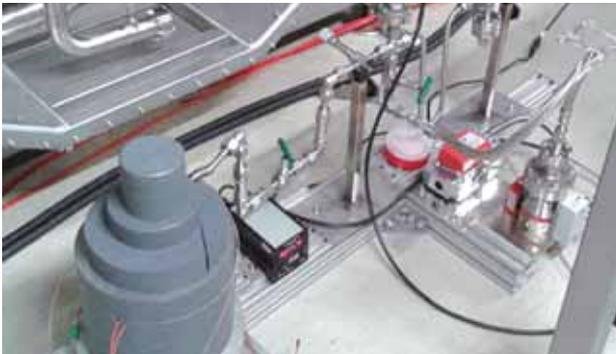
Abb. 10: Krypton- $^{83m}\text{Kr}$ -Generator im TLK, bestehend aus Rubidium-Präparat (in Bleiburg) und  $^{83m}\text{Kr}$  Einlasssystem in KATRIN-Quelle.
