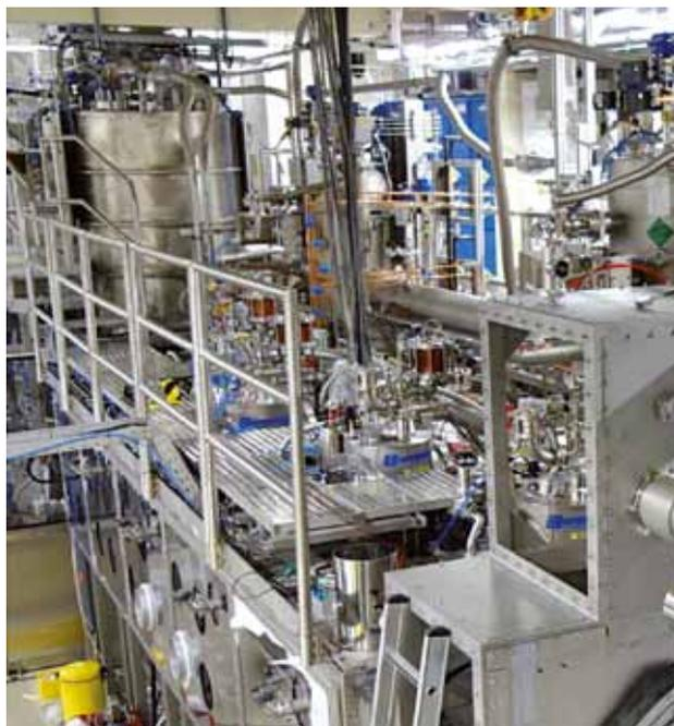
**Abb. 8:** Blick auf den STS-Bereich. Das DPS-System wird gerade in eine Handschuhbox verpackt, verfahrenstechnisch verrohrt und automatisierungstechnisch verkabelt.
