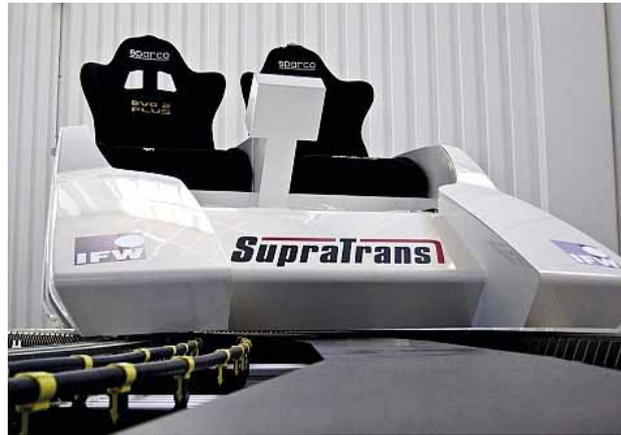
**Abb. 9: Das SupraTrans Transportsystem, basierend auf supraleitenden Magnetlagern.**
