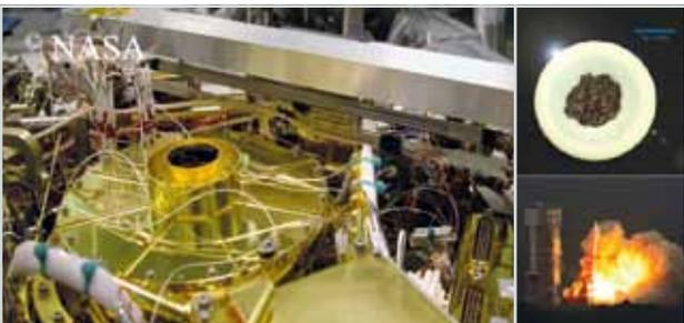
**Abb. 7: Röntgenspektrometer XRS-2 (links), MgB<sub>2</sub>-Draht (rechts oben) und Start der Rakete (rechts unten).**
