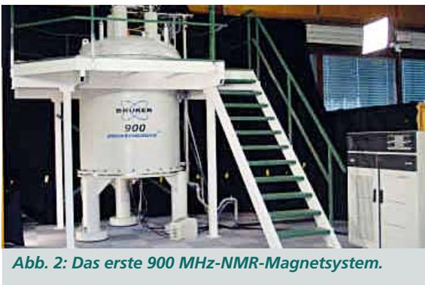
**Abb. 2:** Das erste 900 MHz-NMR-Magnetsystem.
