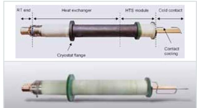
Abb. 12: Stromzuführungen für W7-X (oben) und JT60-SA (unten).
