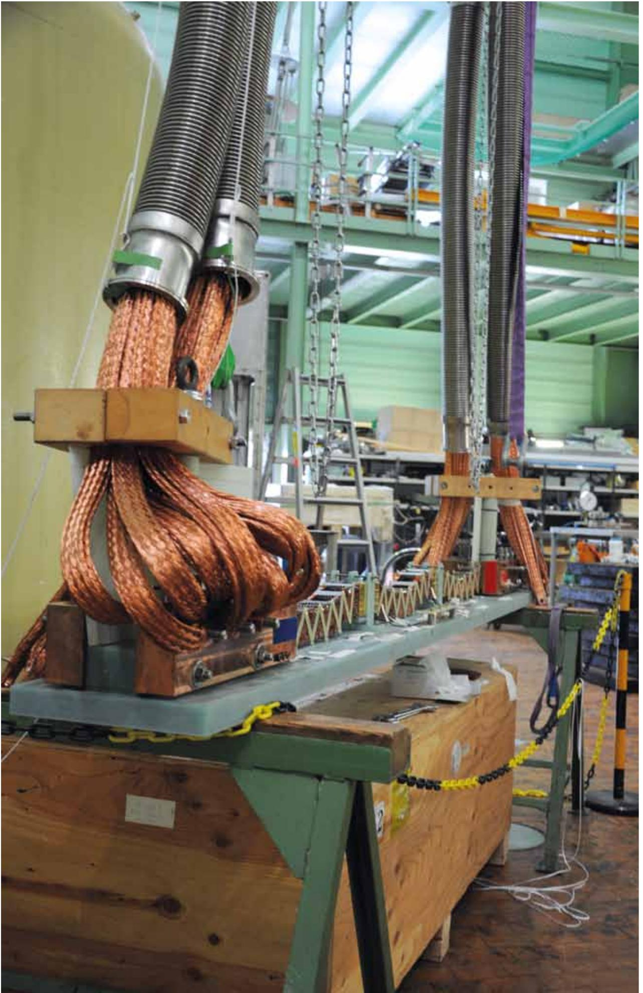
*Experiment zum Transportstromtest an einer kontaktierten supraleitenden 3S-Subscale-Stromschiene (welliges Objekt zwischen den Stromzuführungskabeln).*
