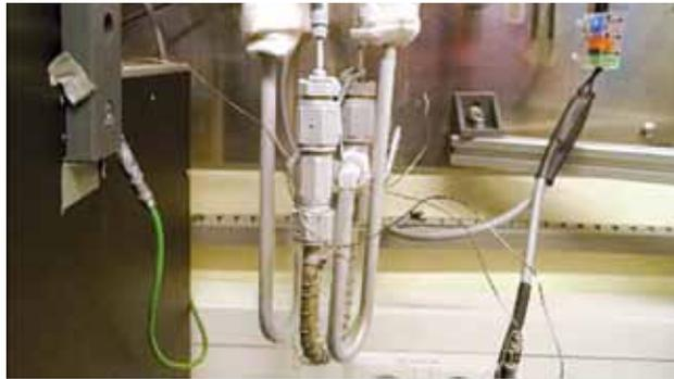
**Abb. 5: Konverter des Testaufbaus. Das mittlere U-Rohr enthält das Katalysatormaterial. Am Ein- und Ausgang des U-Rohrs befindet sich jeweils ein Pt-100-Sensor zur Temperaturmessung.**
