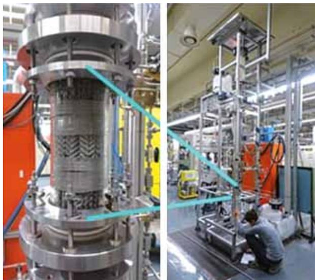
Abb. 2: Ein Ausschnitt aus der untersuchten strukturierten Kolonnenpackung (links) sowie der gesamte Versuchsaufbau (rechts).
