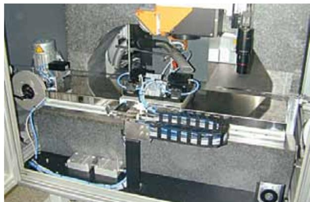
Abb. 9: Laseranlage mit Lineartisch und Reel-to-Reel-Einheit.
